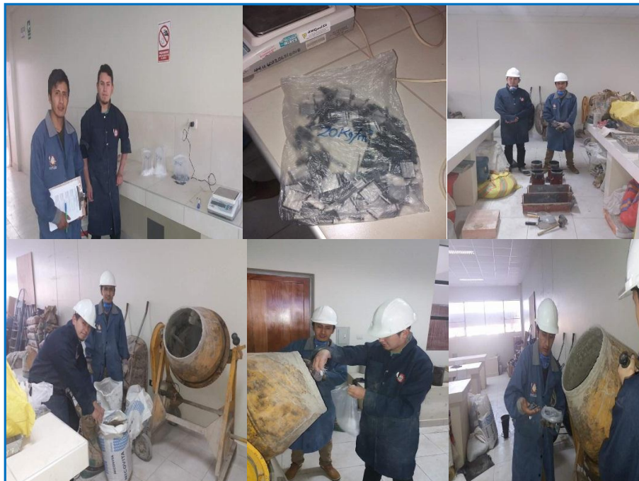
Figura 3.10: Proceso de elaboración del concreto normal, con adición de fibras metálicas y fibras de polipropileno.
