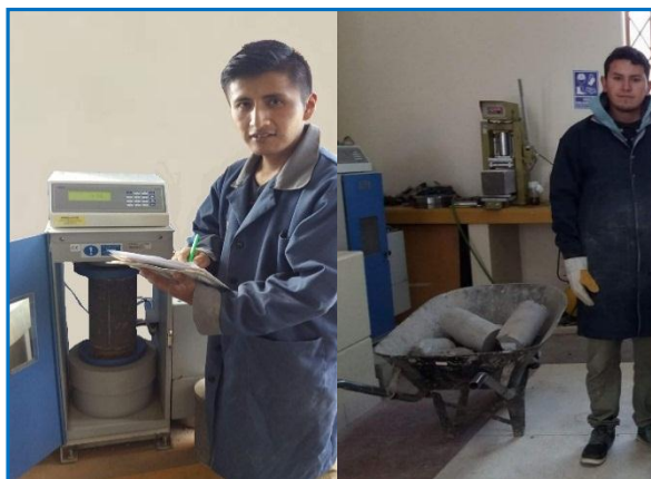
Figura 3.15: Ensayo de resistencia a la compresión del concreto.
