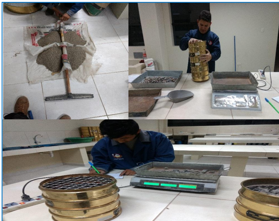
Figura 3.2: Ensayo Análisis Granulométrico del Agregado Fino y Agregado Grueso.
