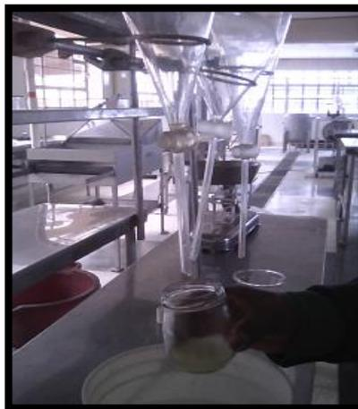
Figura 6. a) Destiladora de aceite esencial de Muña y Paico mediante el método de arrastre por vapor, b) Aceite esencial de Paico extraído mediante un Embudo de Decantación. Facultad de Ingeniería Agroindustrial, UNA-Puno. durante septiembre a octubre 2017.
