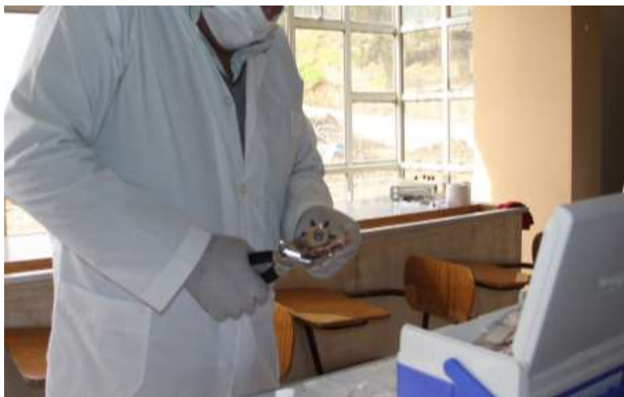
Foto 6: extracción de muestra con ayuda del sacabocado
