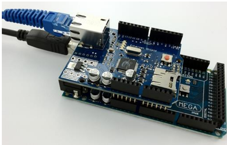
Figura 4.17: Tarjeta Shiel Ethernet montada sobre Arduino Mega 2560 R3
