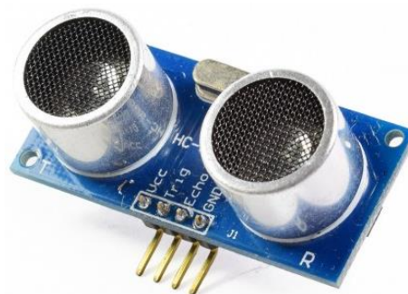
Figura 4.8: Sensor ultrasónico HC-SR04
