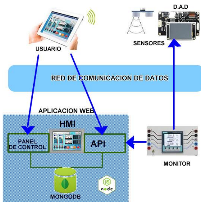
Figura 4.20: Arquitectura de comunicación panel HMI
