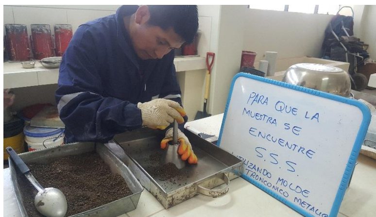
Método del cono, para comprobar si la muestra se encuentra en estado saturado y superficialmente seco (S.S.S) - Laboratorio de la Escuela Profesional de Ingeniería Civil (EPIC – UNA PUNO).
