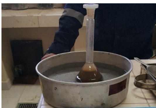
Figura N° 3.16: Colocar la fiola con la muestra, sobre una bandeja con agua a temperatura controlada - Laboratorio de la Escuela Profesional de Ingeniería Civil (EPIC – UNA PUNO). Fecha: 25/08/2017
