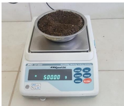
Figura N° 3.12: La muestra S.S.S se pesa - Laboratorio de la Escuela Profesional de Ingeniería Civil Fecha: 25/08/2017
