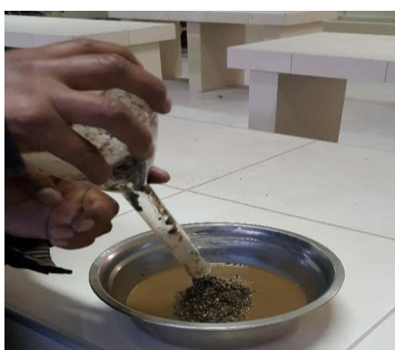
Muestra sacada de la fiola a una tara y llevado al horno- Laboratorio de la Escuela Profesional de Ingeniería Civil (EPIC – UNA PUNO)
