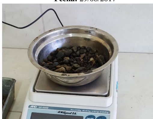
Secando la Muestra para dejarla en S.S.S - Laboratorio de la Escuela Profesional de Ingeniería Civil (EPIC – UNA PUNO). Fecha: 29/08/2017
