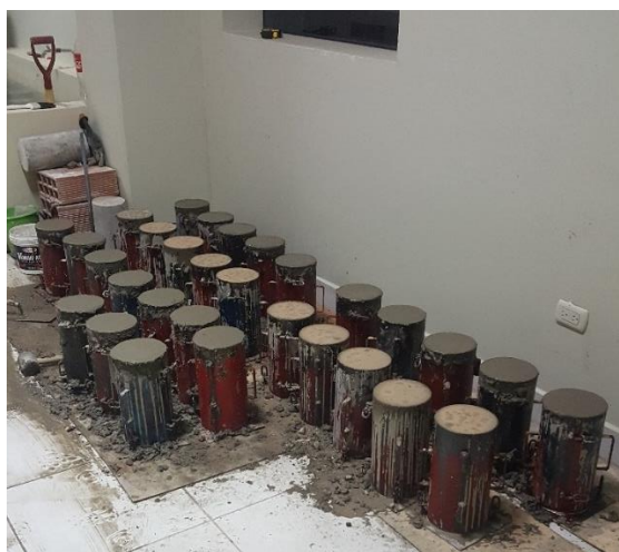
Figura 3.33: Moldes vaciados de un grupo de concreto.
