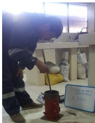
Figura N o 3.20: Peso unitario compactado del agregado fino- Laboratorio de la Escuela Profesional de Ingeniería Civil (EPIC – UNA PUNO)
