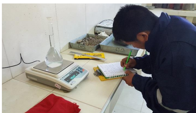
Figura N° 3.13: pesando la fiola más agua - Laboratorio de la Escuela Profesional de Ingeniería Civil (EPIC – UNA PUNO). Fecha: 25/08/2017
