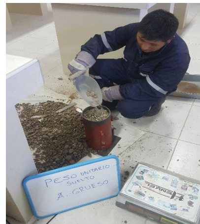
Peso unitario suelto - Laboratorio de la Escuela Profesional de Ingeniería Civil Fecha: 28/08/2017
