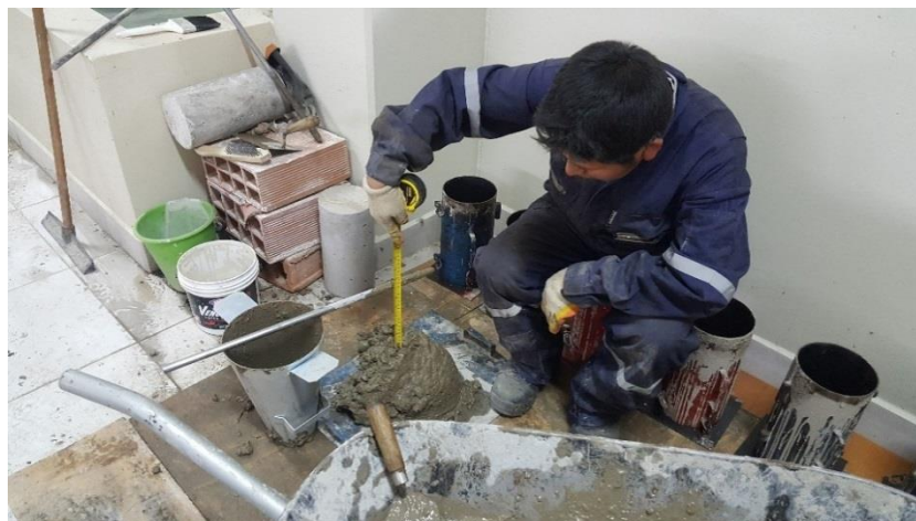
Figura 3.31: Comprobación del asentamiento. Fecha: 12/09/2017
