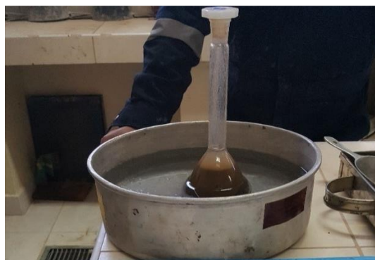
Colocar la fiola con la muestra, sobre una bandeja con agua a temperatura controlada - Laboratorio de la Escuela Profesional de Ingeniería Civil (EPIC – UNA PUNO).
