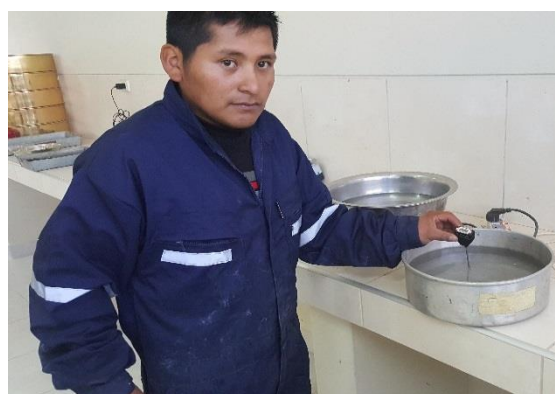
Eliminación de burbujas de aire del agregado fino - Laboratorio de la Escuela Profesional de Ingeniería Civil (EPIC – UNA PUNO). Fecha: 25/08/2017
