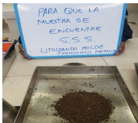
Figura N° 3.11: La muestra se desmorona después del ensayo, con lo cual comprobamos que se encuentra (S.S.S) - Laboratorio de la Escuela Profesional de Ingeniería Civil (EPIC – UNA PUNO).
