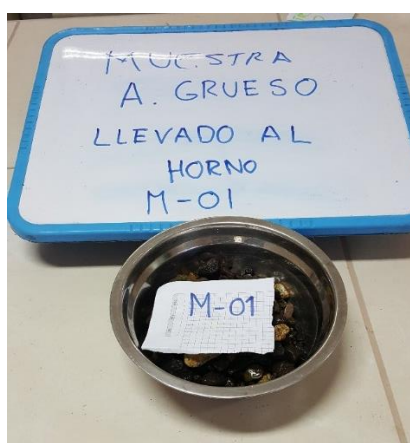
Figura N° 3.26: Colocar el material en un recipiente y llevarlo al horno - Laboratorio de la Escuela Profesional de Ingeniería Civil (EPIC – UNA PUNO)
