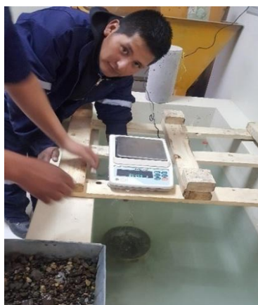
Figura N° 3.25: Material dentro de la canastilla sumergida y luego procedemos a pesarlo - Laboratorio de la Escuela Profesional de Ingeniería Civil (EPIC – UNA PUNO).
