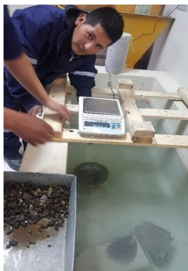
Material dentro de la canastilla sumergida y luego procedemos a pesarlo - Laboratorio de la Escuela Profesional de Ingeniería Civil (EPIC – UNA PUNO).
