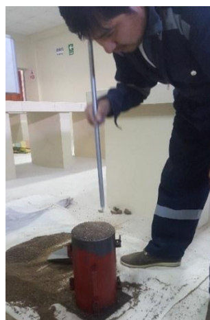
Peso unitario compactado del agregado fino- Laboratorio de la Escuela Profesional de Ingeniería Civil (EPIC – UNA PUNO) Fecha: 28/08/2017
