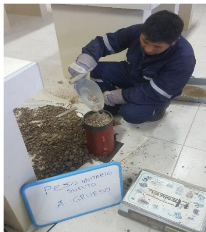
Figura N° 3.27: Peso unitario suelto - Laboratorio de la Escuela Profesional de Ingeniería Civil Fecha: 28/08/2017
