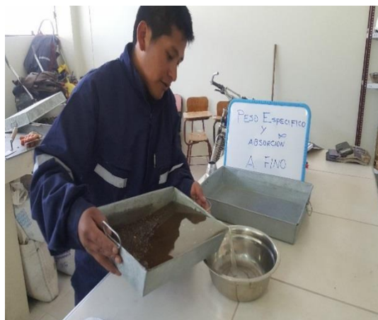
Figura 3.6: Se está haciendo escurrir el agua para que seque superficialmente al medio ambiente - Laboratorio de la Escuela Profesional de Ingeniería Civil (EPIC – UNA PUNO).
