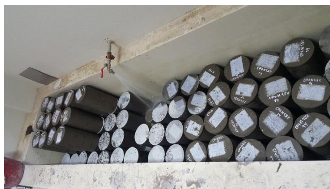
Figura 3.35: Colocado de las muestras a la poza. Fecha: 14/09/2017
