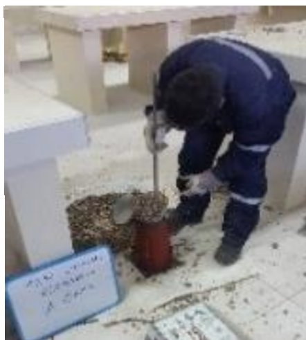
Figura N° 3.28: Peso unitario compactado - Laboratorio de la Escuela Profesional de Ingeniería Civil Fecha: 28/08/2017
