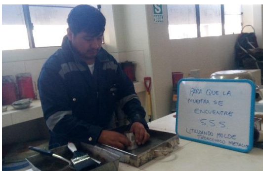
Muestra que no se encuentra aún en estado saturado y superficialmente seco (S.S.S) - Laboratorio de la Escuela Profesional de Ingeniería Civil (EPIC – UNA PUNO).
