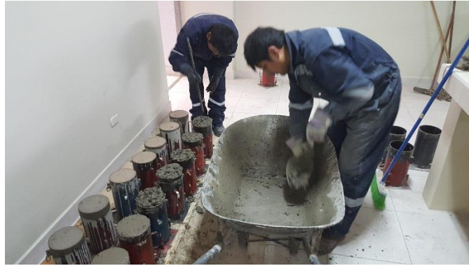
Llenado de moldes y apisonado de mezcla de concreto en tres capas iguales. Fecha: 12/08/2017
