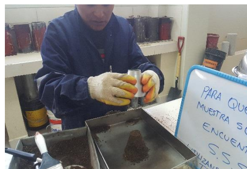
Muestra que no se encuentra aún en estado saturado y superficialmente seco (S.S.S) - Laboratorio de la Escuela Profesional de Ingeniería Civil (EPIC – UNA PUNO).
