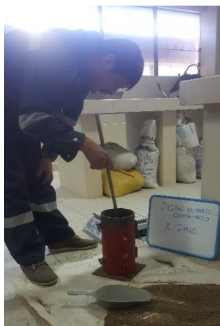
Peso unitario compactado del agregado fino- Laboratorio de la Escuela Profesional de Ingeniería Civil (EPIC – UNA PUNO) Fecha: 28/08/2017
