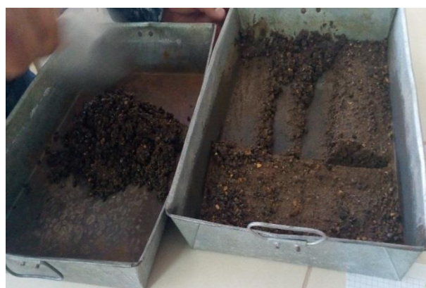
Figura 3.7 Se está sacando la muestra luego de escurrirlo -laboratorio de la Escuela Profesional de Ingeniería Civil (EPIC – UNA PUNO)
