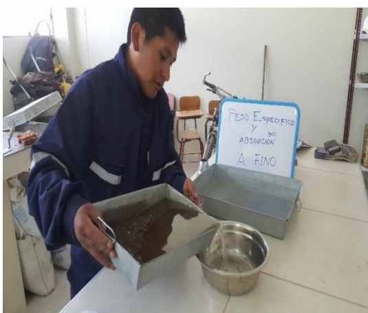
Se está haciendo escurrir el agua para que seque superficialmente al medio ambiente - Laboratorio de la Escuela Profesional de Ingeniería Civil (EPIC – UNA PUNO).
