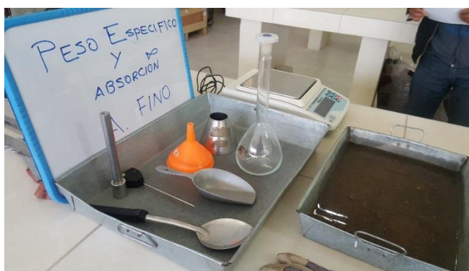
Figura 3.5: Equipos y materiales para el ensayo de peso específico y absorción - Laboratorio de la Escuela Profesional de Ingeniería Civil (EPIC – UNA PUNO).
