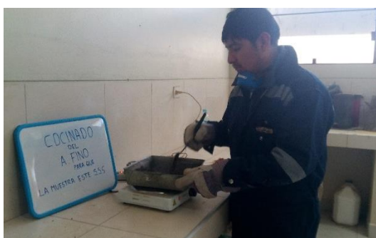
Figura 3.8: Se está calentando la muestra en una cocina eléctrica - laboratorio de la Escuela Profesional de Ingeniería Civil (EPIC – UNA PUNO)
