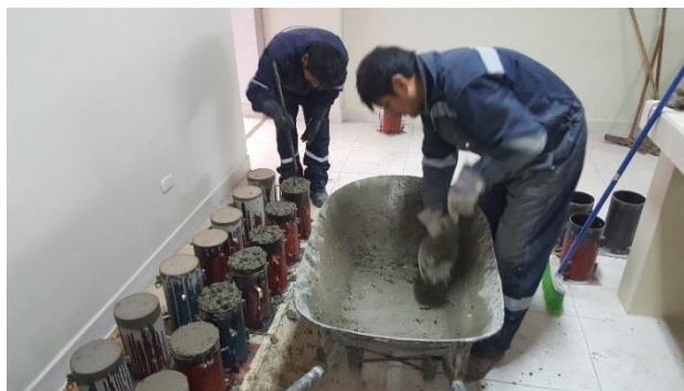
Figura 3.32: Llenado de moldes y apisonado de mezcla de concreto en tres capas iguales.
