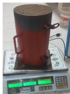
Peso unitario suelto agregado fino- Laboratorio de la Escuela Profesional de Ingeniería Civil (EPIC – UNA PUNO)
