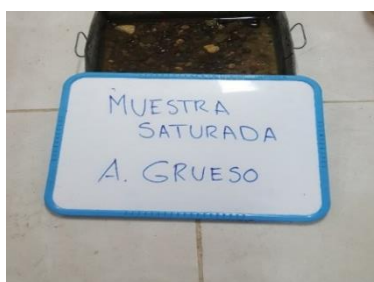
Figura N° 3.22: Muestra sumergida durante 24 horas - Laboratorio de la Escuela Profesional de Ingeniería Civil (EPIC – UNA PUNO).
