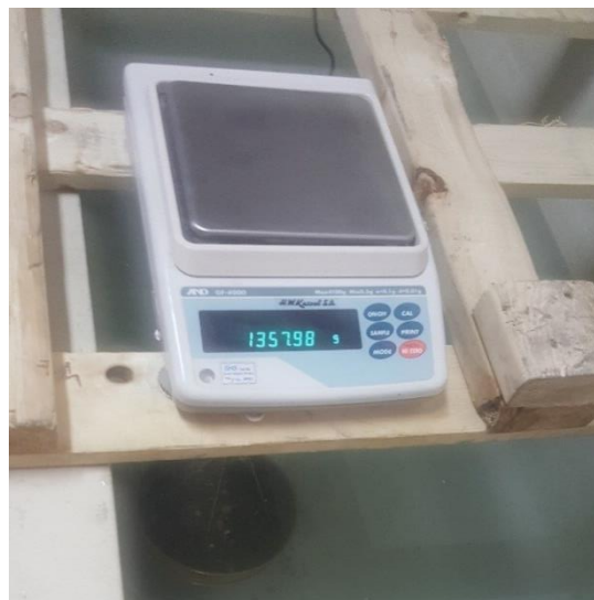
Material dentro de la canastilla sumergida y luego procedemos a pesarlo - Laboratorio de la Escuela Profesional de Ingeniería Civil (EPIC – UNA PUNO).
