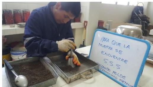
Figura N° 3.9: Método del cono, para comprobar si la muestra se encuentra en estado saturado y superficialmente seco (S.S.S) - Laboratorio de la Escuela Profesional de Ingeniería Civil (EPIC – UNA PUNO).
