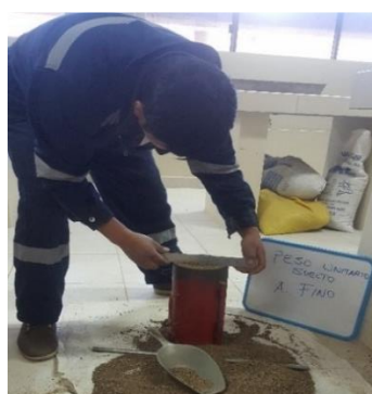
Figura N° 3.18: Peso unitario suelto agregado fino- Laboratorio de la Escuela Profesional de Ingeniería Civil (EPIC – UNA PUNO) Fecha: 28/08/2017
