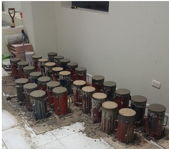
Moldes vaciados de un grupo de concreto. Fecha: 13/08/2017
