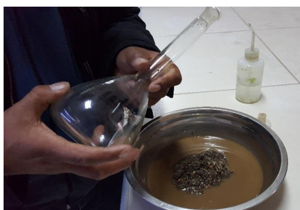
Muestra sacada de la fiola a una tara y llevado al horno- Laboratorio de la Escuela Profesional de Ingeniería Civil (EPIC – UNA PUNO)
