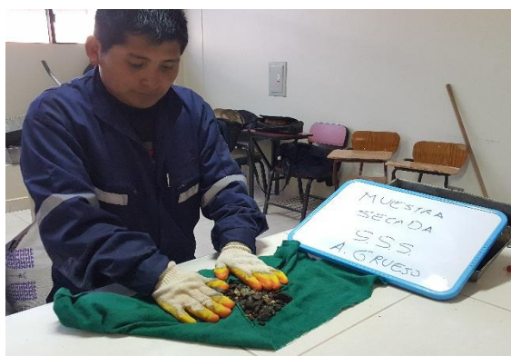
Secando la Muestra para dejarla en S.S.S - Laboratorio de la Escuela Profesional de Ingeniería Civil (EPIC – UNA PUNO). Fecha: 29/08/2017
