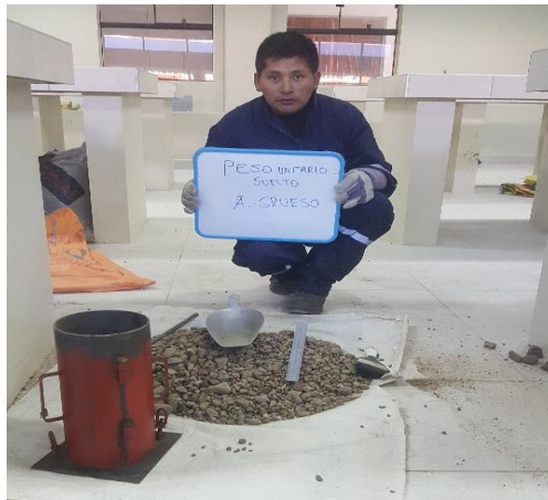
Peso unitario suelto - Laboratorio de la Escuela Profesional de Ingeniería Civil Fecha: 28/08/2017
