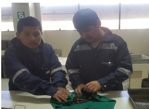
Figura N° 3.23: Secando la Muestra para dejarla en S.S.S - Laboratorio de la Escuela Profesional de Ingeniería Civil (EPIC – UNA PUNO).
