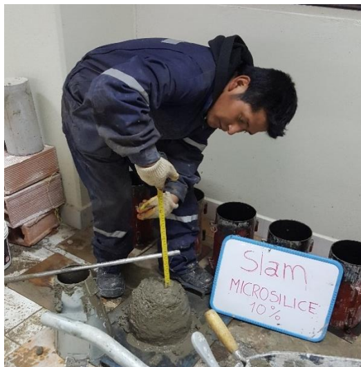
Figura 3.36: Ensayo de asentamiento cono de Abrams. Fecha: 14/08/2017
