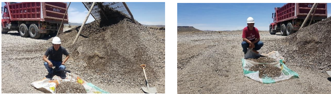
Figura 3.1: muestreo en cantera y acumulación de partes opuestas del agregado Fecha: 10/08/17
