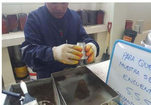
Figura N° 3.10: Muestra que no se encuentra aún en estado saturado y superficialmente seco (S.S.S) - Laboratorio de la Escuela Profesional de Ingeniería Civil (EPIC – UNA PUNO).
