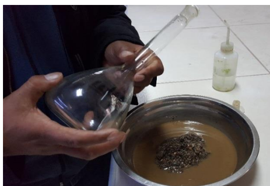
Figura N° 3.17: Muestra sacada de la fiola a una tara y llevado al horno - Laboratorio de la Escuela Profesional de Ingeniería Civil (EPIC – UNA PUNO) Fecha: 25/08/2017
