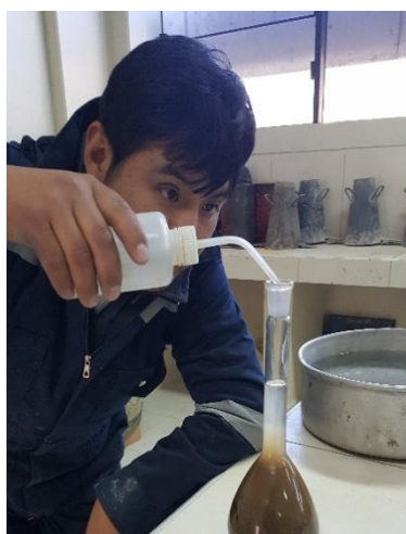
Figura N° 3.14: Colocando la muestra s.s.s en la fiola - Laboratorio de la Escuela Profesional de Ingeniería Civil (EPIC – UNA PUNO). Fecha: 25/08/2017
