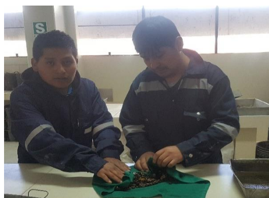
Secando la Muestra para dejarla en S.S.S - Laboratorio de la Escuela Profesional de Ingeniería Civil (EPIC – UNA PUNO). Fecha: 29/08/2017
