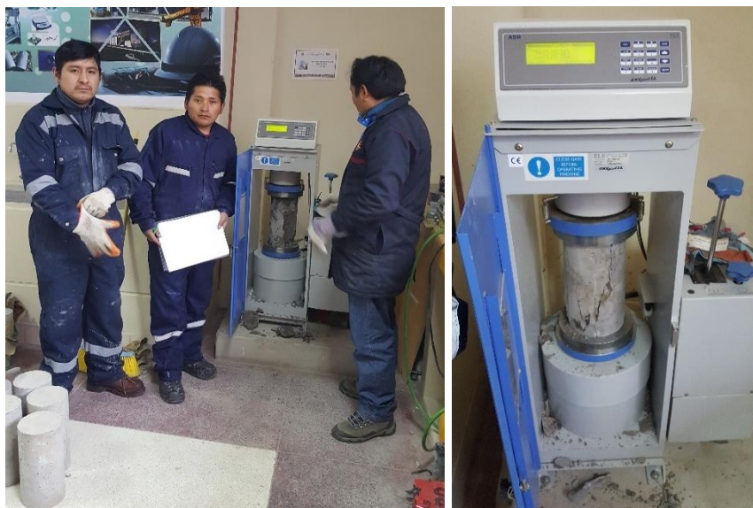
Figura N° 3.37: Ensayo de resistencia a compresión. Fecha: 12/09/2017
