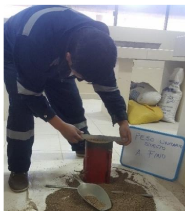
Peso unitario suelto agregado fino- Laboratorio de la Escuela Profesional de Ingeniería Civil (EPIC – UNA PUNO)
