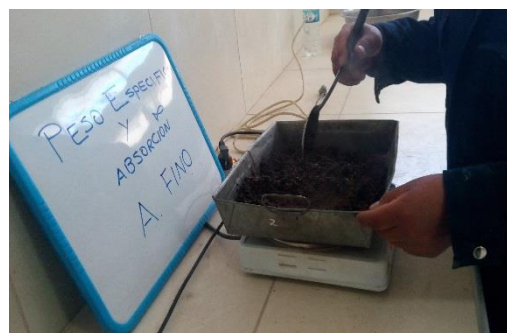
Se está calentando la muestra en una cocina eléctrica -laboratorio de la Escuela Profesional de Ingeniería Civil (EPIC – UNA PUNO)
