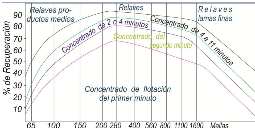
Figura N°07: Flotación de minerales de cobre el concentrado primario de acuerdo por el tamaño granular de las partículas
