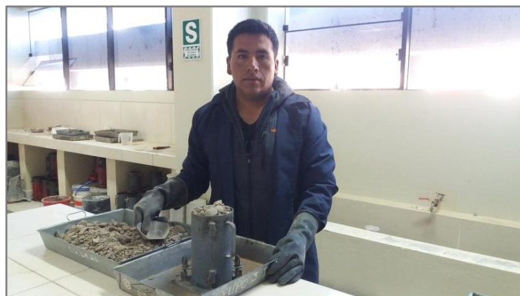
Figura 20. Colocación del agregado grueso al recipiente para el cálculo del P. U. Suelto y compactado.
