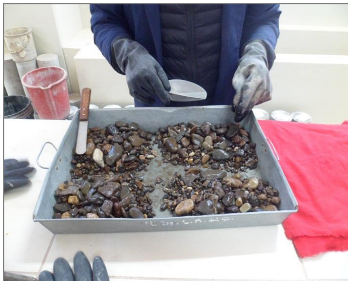
Figura 18. Se observa cuarteo del agregado grueso.
