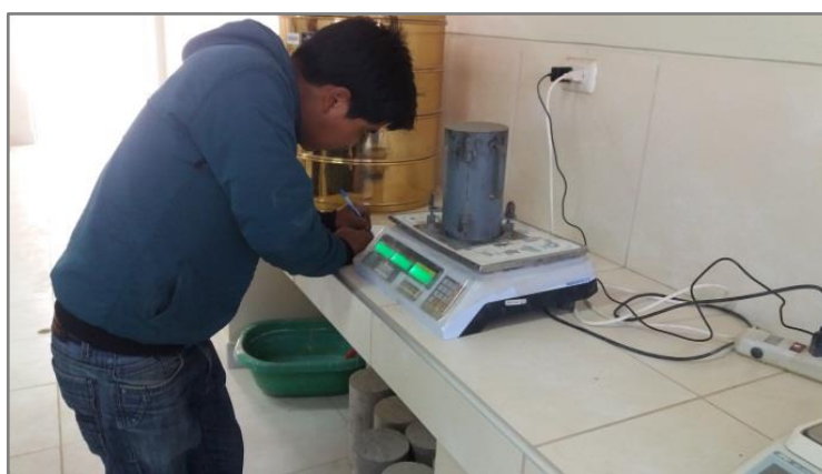
Figura 14. Enrasado y pesado del recipiente con la muestra para el cálculo del Peso Unitario Suelto.
