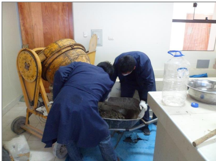
Figura 27. Extracción Mezclado del concreto de diseño
