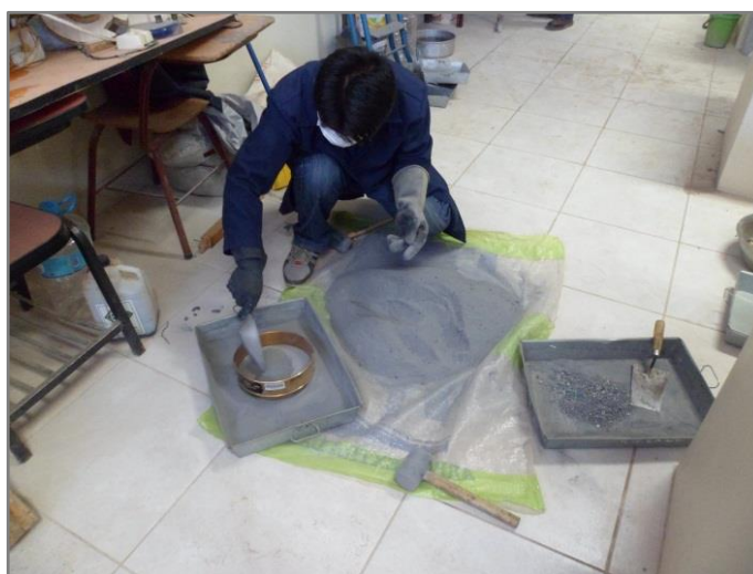
Figura 22. Secado y tamizado del relave minero.
