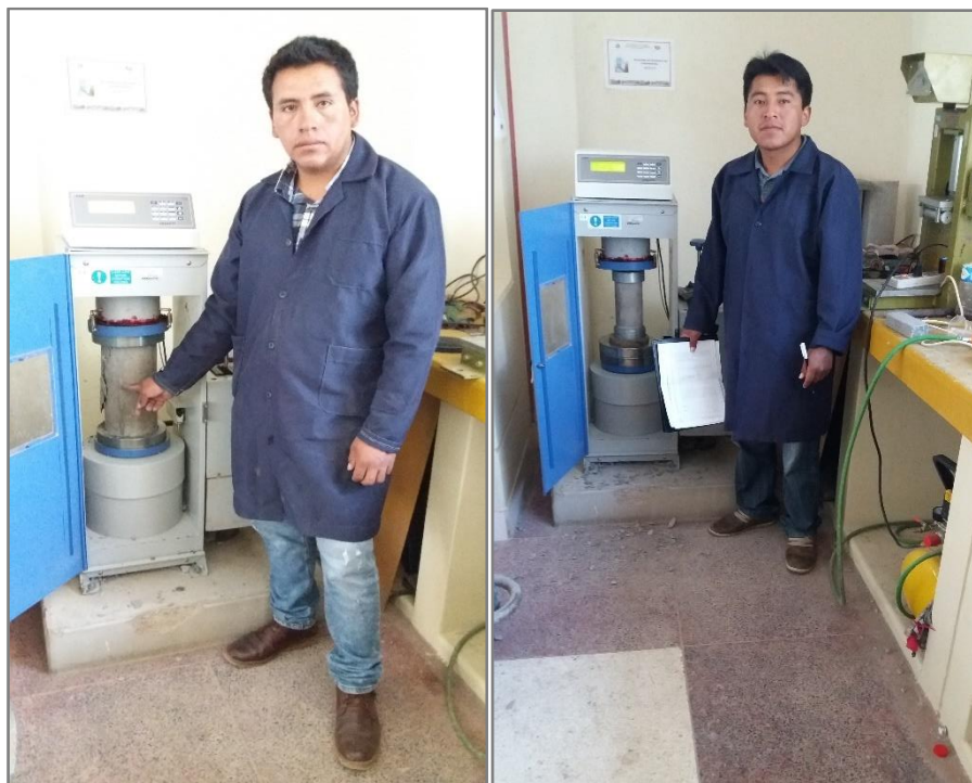
Figura 36. Rotura de briquetas de 6"x12" y de 4"x8" respectivamente.
