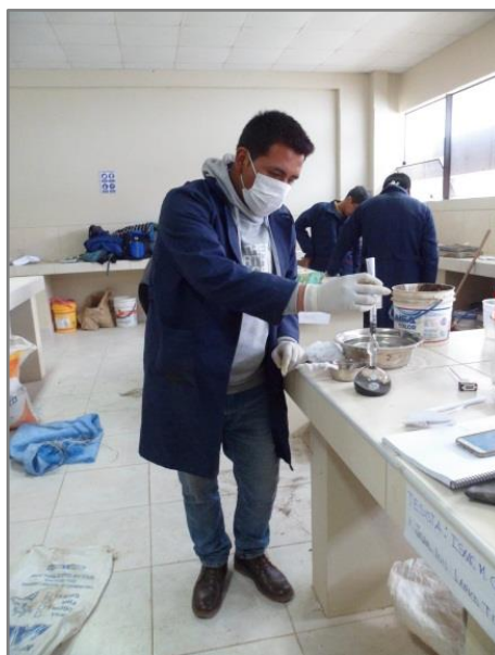
Figura 23. Ensayo para determinar peso específico del relave.
