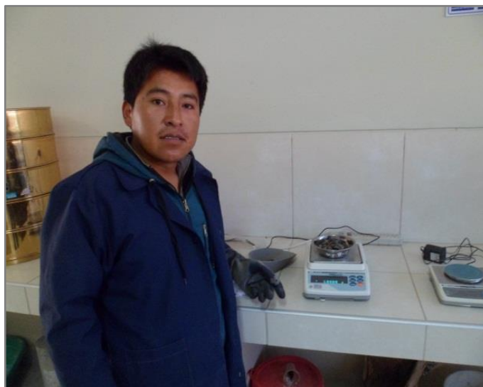
Figura 19. Se observa el pesado del agregado grueso en SSS .
