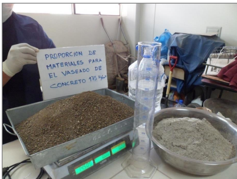
Figura 26. Pesado de los materiales para el diseño del concreto.
