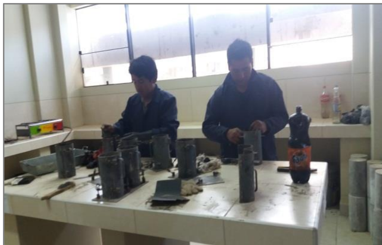
Figura 25. Preparación de los moldes para el vaciado del concreto.
