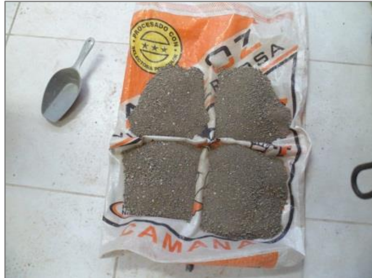
Figura 6. Se observa el cuarteo del agregado fino.
