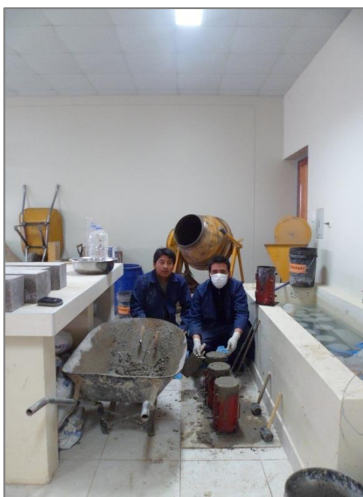
Figura 28. Moldes vaciados con concreto, para su posterior desencofrado luego de 24 horas de vaciado.
