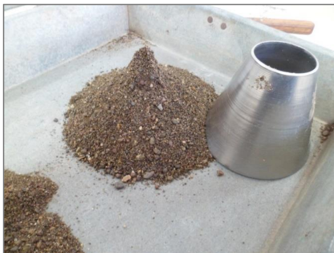
Figura 11. Agregado fino en estado (SSS) después del apisonado.
