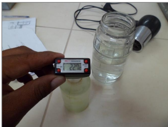
Figura 13. Control de temperatura del agua.
