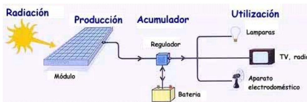
Figura 141. funcionamiento de los paneles fotovoltaicos. Fuente: http://www.solener.com/pregunta.html .
