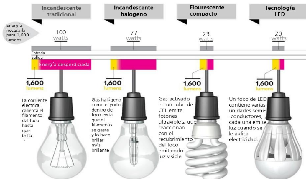
Figura 142: Cuadro Comparativo de luminarias convencionales y led Fuente: Estudios de iluminación de Instalaciones técnicas y mantenimiento S.A
