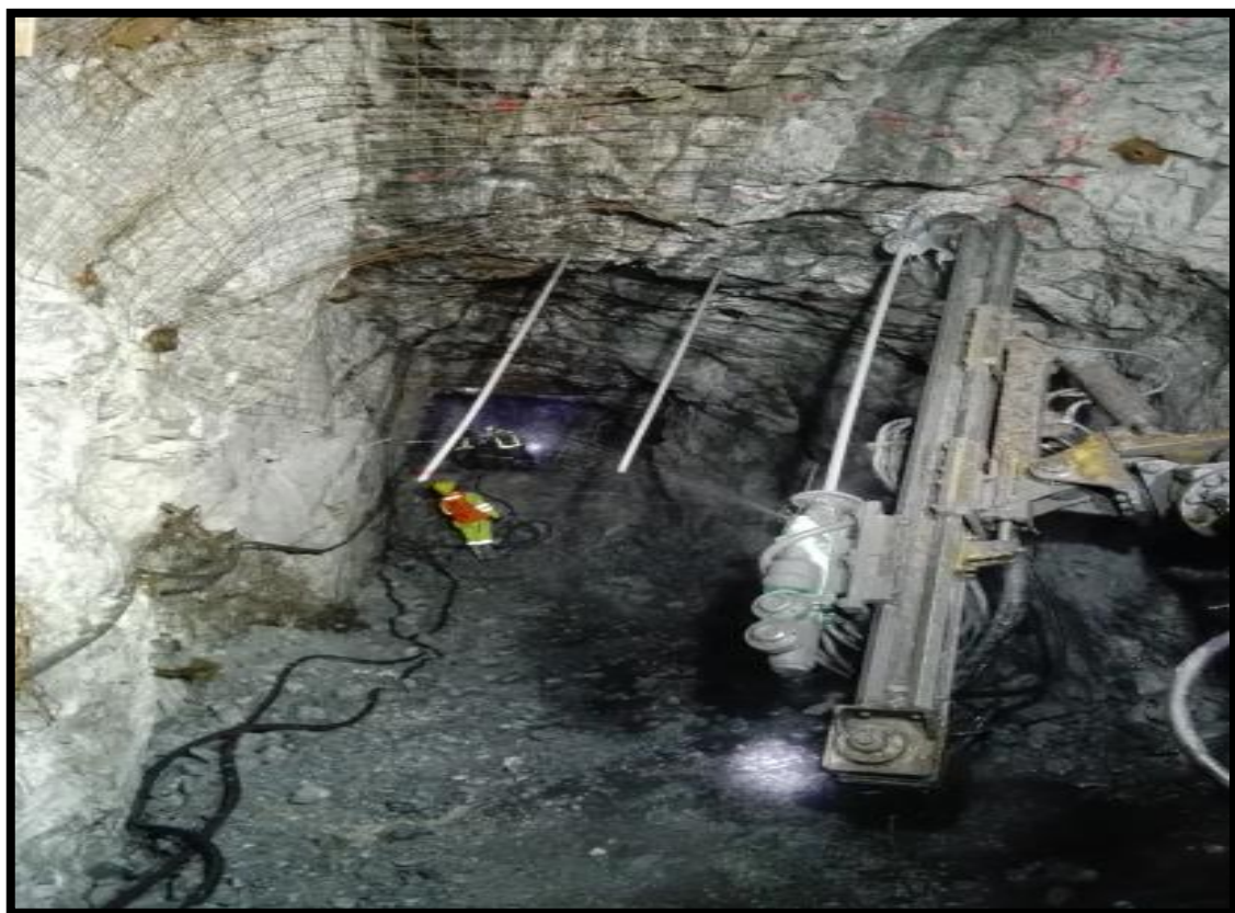
Figura 14: Taladros perforados con guidores Fuente: Elaboración propia
