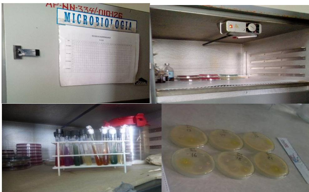
Figura 21. Incubando todos los medios de cultivo Mc conkey, Agar sangre, Cleed y medios diferenciales en la estufa a 37°C por 24 horas para su crecimiento.
