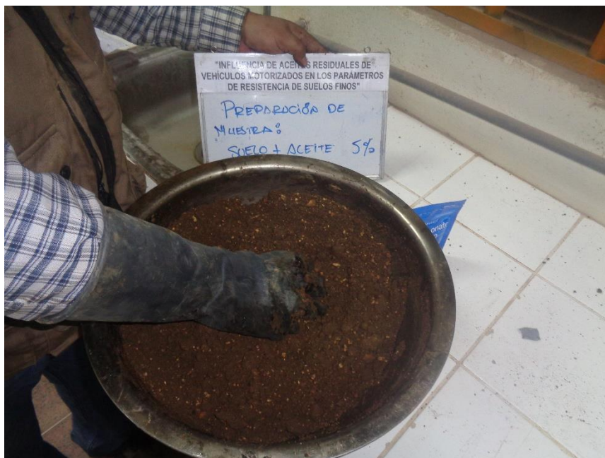
Figura 4. 1 Se muestra la mezcla suelo - aceite residual para determinar su efecto a incrementos sucesivos.
