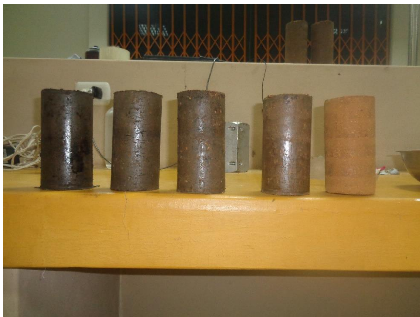
Figura 1. 2 Especímenes remoldeados para el ensayo triaxial UU
