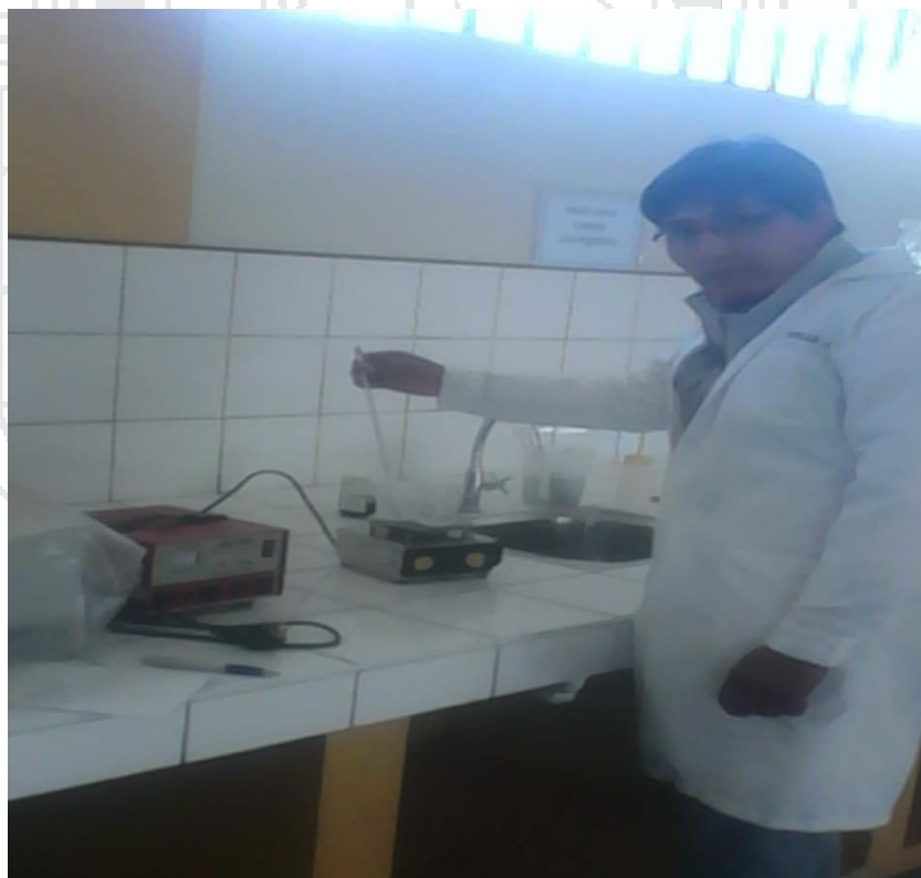
FOTO 02: MEDICION DE LA TEMPERATURA ÓPTIMA DE CRISTALIZACION
