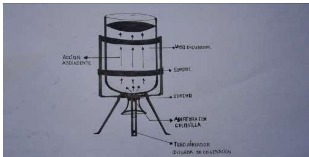
**Figura 2.** Diagrama de funcionamiento de incubadora tipo Veys, *Fuente propia.*
