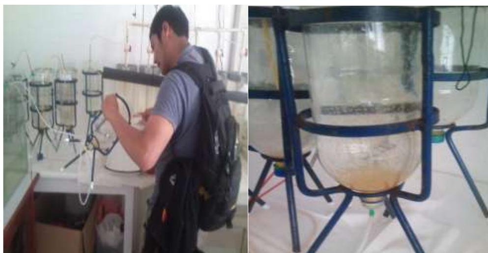
**Figura 21.** Proceso de funcionamiento de la incubadora tipo VEYS (flujo ascendente) - Investigación realizada en el Instituto del mar del Perú (IMARPE) - PUNO
