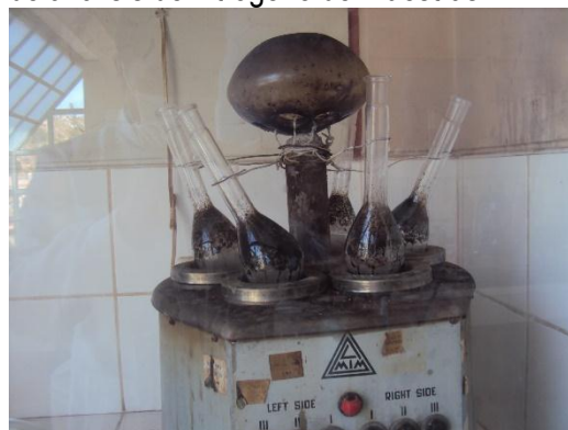
IMAGEN 28: Fase de destilación del proceso de análisis de nitrógeno de muestras.
