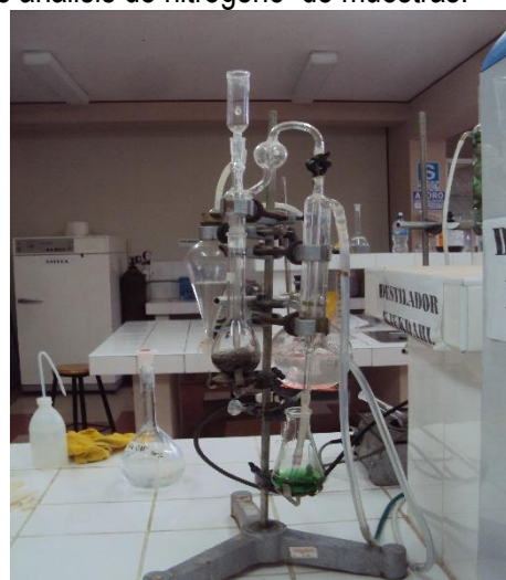
IMAGEN 29: Fase de titulación del proceso de análisis de nitrógeno de las muestras.
