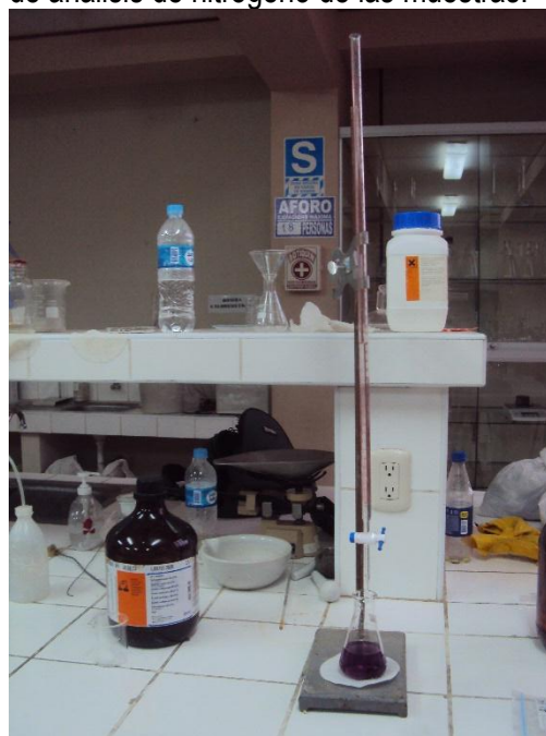
IMAGEN 29: Fase de titulación del proceso de análisis de nitrógeno de las muestras.
