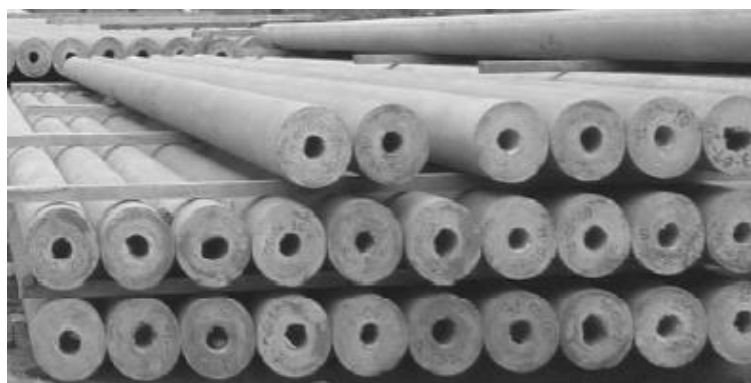
Figura 12. Poste de C.A.C., y puntos de apoyo.
