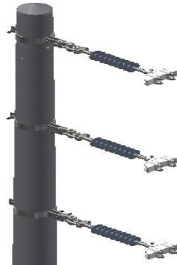
Figura 2. Armado de ángulo.
