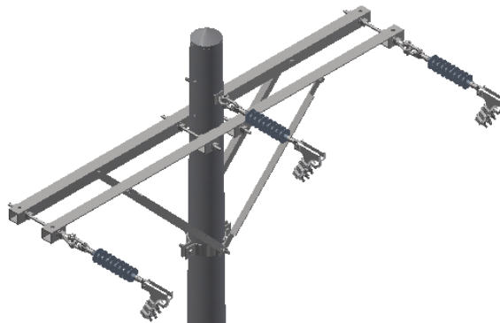
Figura 4. Armado fin de línea.
