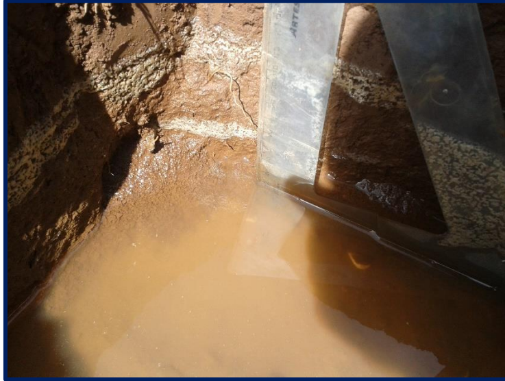
Imagen 1: medición de infiltración en cubeta de 30x30cm
