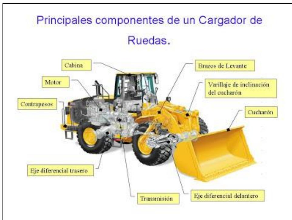
Figura 2.12 Partes de un cargador frontal.
