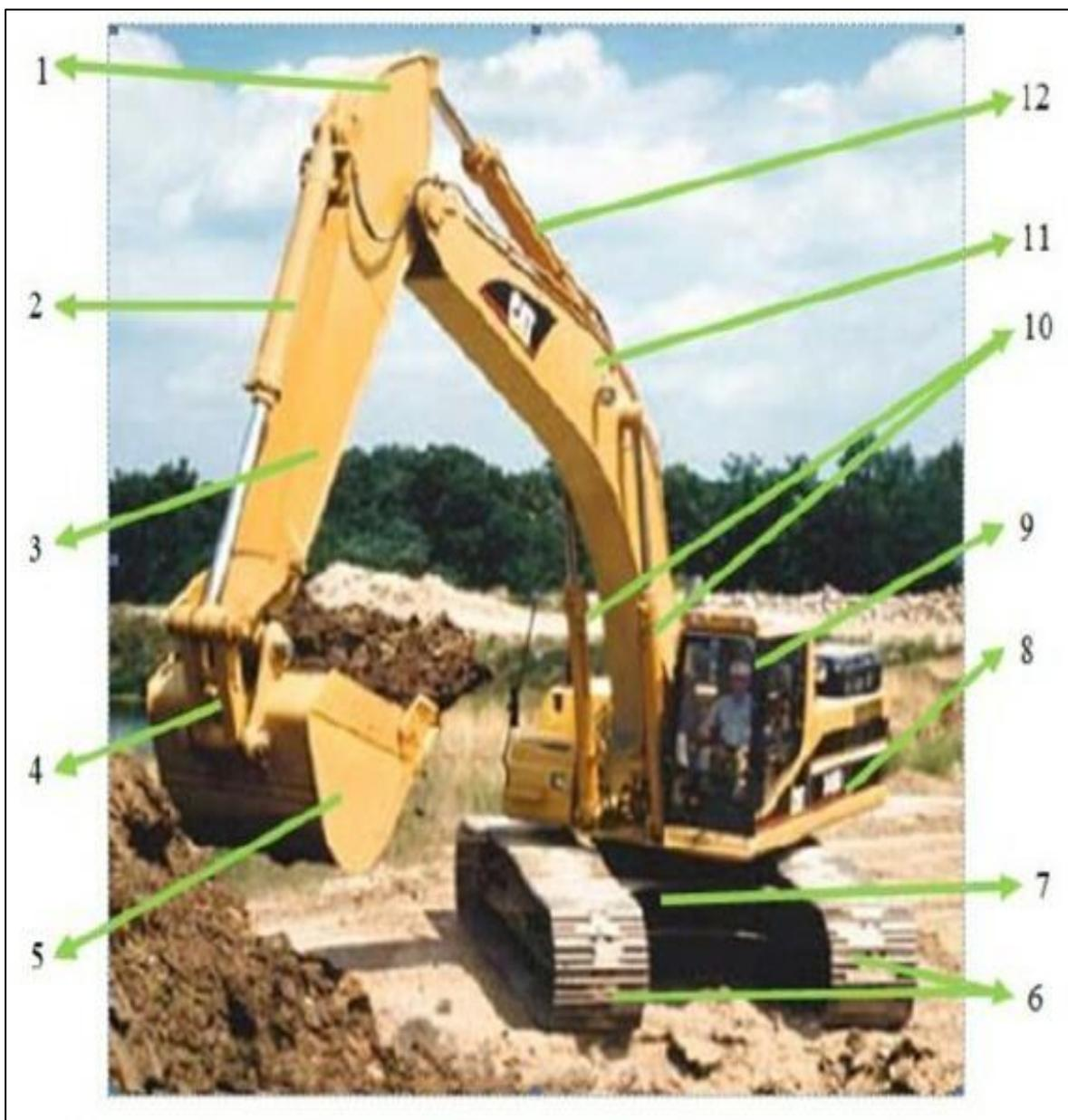
Figura 2.6 Partes de una excavadora hidráulica.
