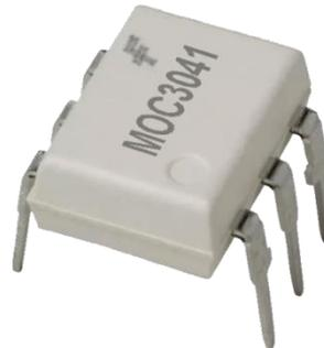
**Figura 22:** En esta imagen se muestra que una ilustración de MOC3041 de Fairchild
