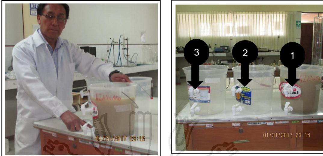
**Figura 4.** Proceso de purificación de arcillas comestibles mediante el método de sedimentación.
