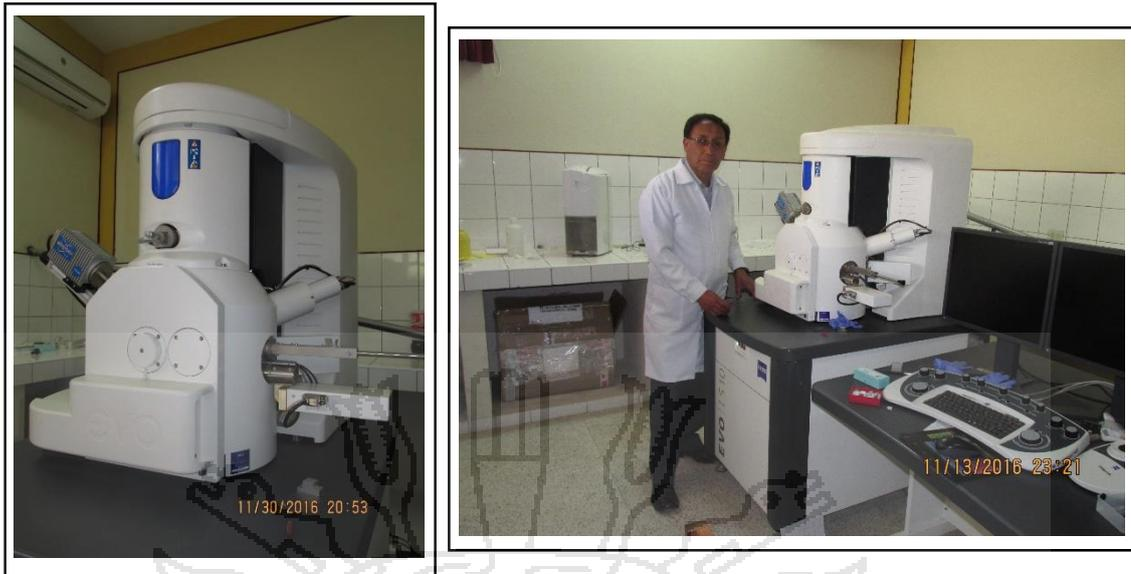
**Figura 7.** Microscopio Electrónico de Barrido ZEISS, modelo EVO LS10.
