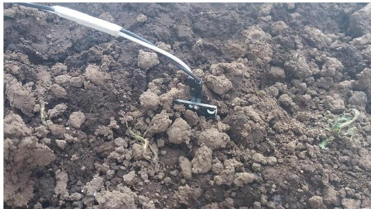
Figura 76. Medición de la humedad del suelo, imagen tomada 20/11/2017.
