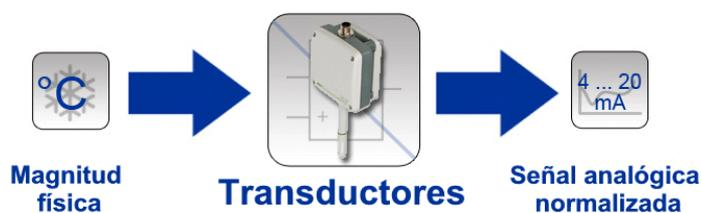
Figura 1: Diagrama de función de un transductor.
