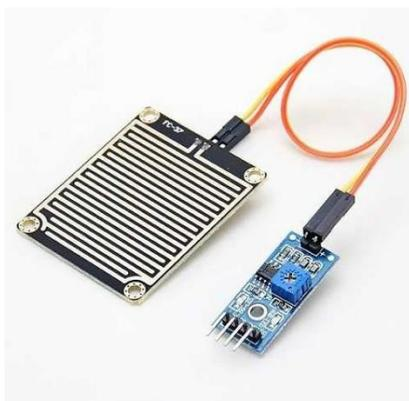
Figura 13: Módulo de sensor de lluvia,
