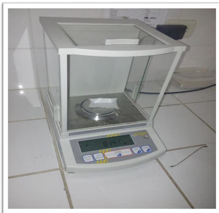
FIGURA N° 1 Determinación del peso de azul de metileno en la Balanza electrónica analítica PROBACSSA.
