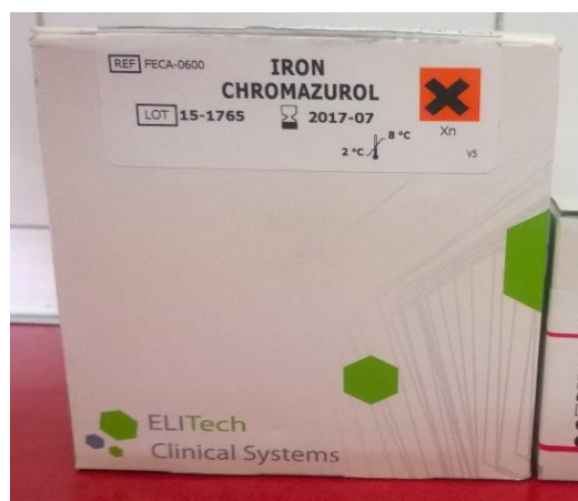
Figura 6. Reactivo para la determinación de hierro (Iron Chromazurol).
