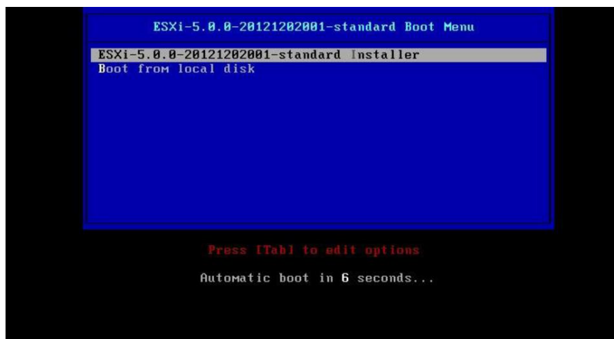
Figura N° 27: Pantalla de inicio de instalación de VMware vsphere ESXi.
