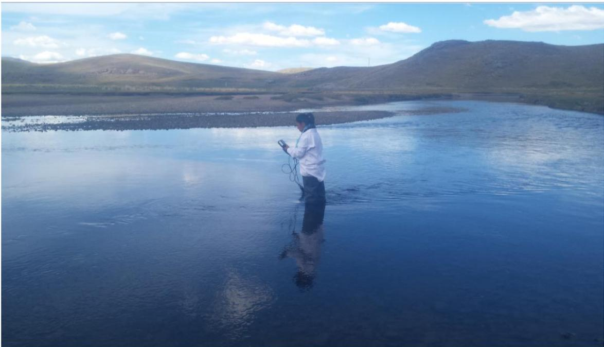
**FOTOGRAFIA 06: SE APRECIA A UN TECNICO LABORATORISTA DEL PELT MIDIENDO LA CANTIDAD DE OXIGENO DISUELTOS EN EL RIO.**
