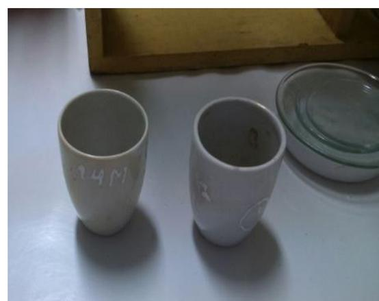
Img. 16: Colocado de muestra en crisoles.
