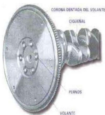
Figura: 7 Partes del Disco de inercia
