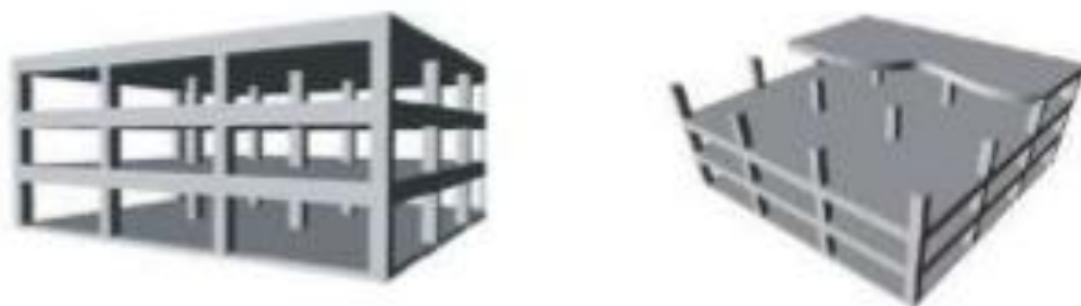
Imagen 42.- Sistema constructivo aporticado
