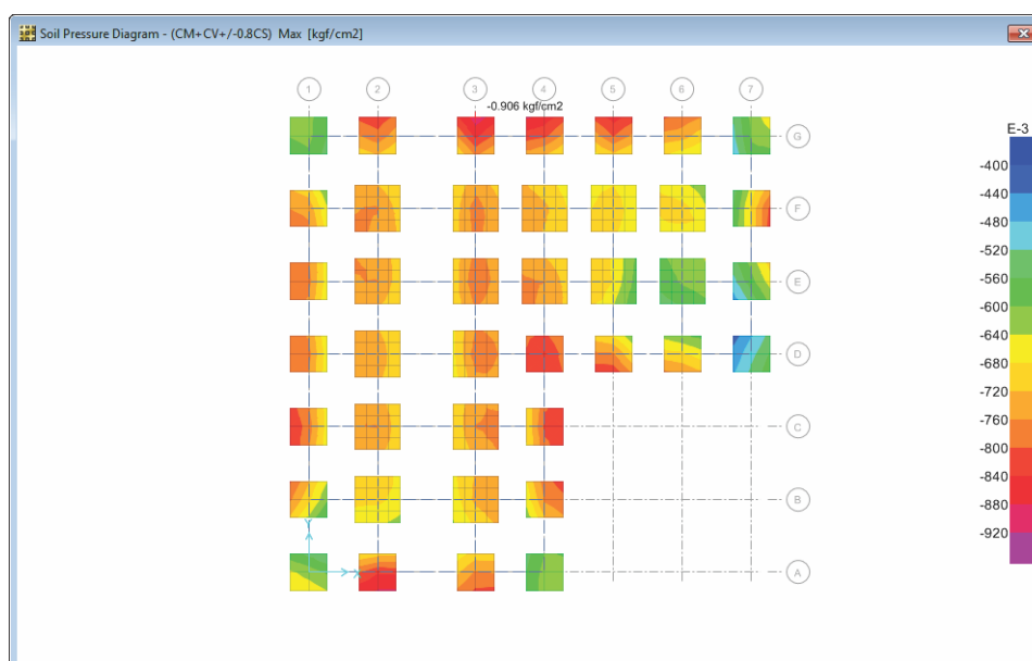
Figura 5.36. Presiones debidas a cargas de grav. y sismo - Bloque 19 Aisl.(Kg/cm2)
