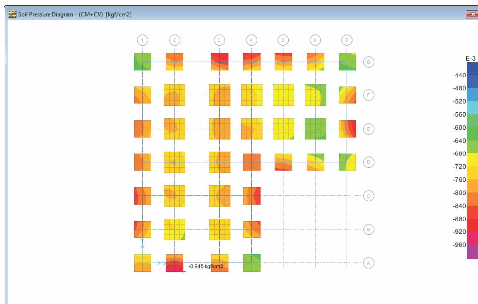
Figura 5.35. Presiones debidas a cargas de gravedad - Bloque 19 Aislado (Kg/cm2)
