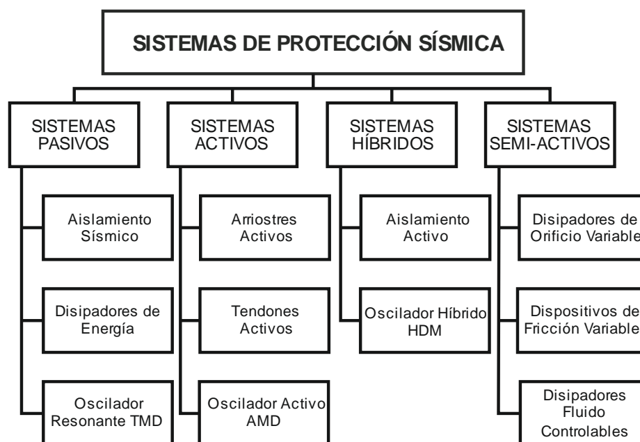
Figura 2.1. Cuadro de Sistemas de Protección Sísmica
