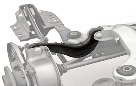
Figura 10: Brazo instalado en una suspensión
