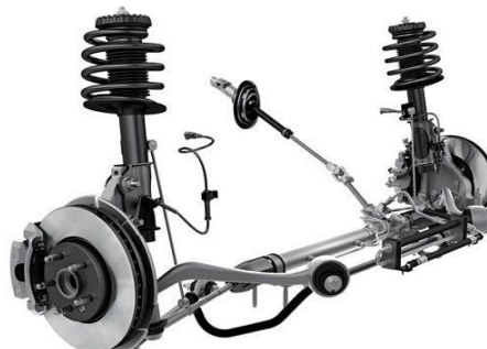
Figura 22: Esquema suspensión McPherson en un eje delantero
