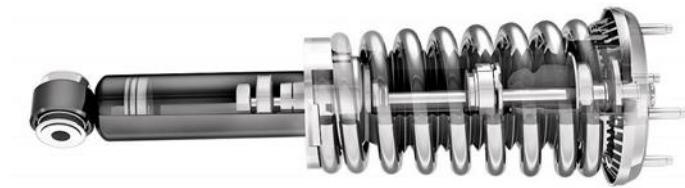
Figura 9: detalle de un amortiguador “monotubo” de un jaguar XF
