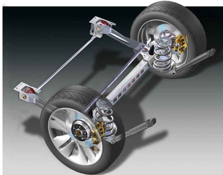
Figura 16: Eje regido instalado en un Renault Espace
