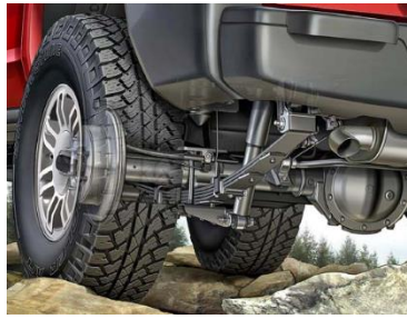
Figura 7: Ballesta instalada en el eje trasero de un Humer H2
