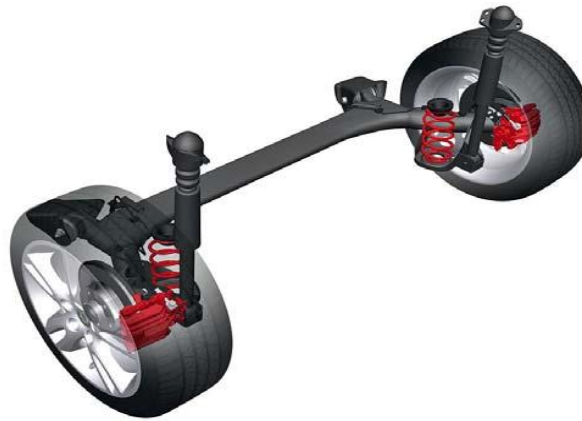
Figura 21: Suspensión trasera semirrígida de brazo tirado
