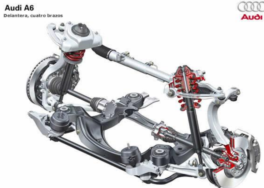
Figura 25: Esquema de una suspensión multibrazo delantero de un Audi A6
