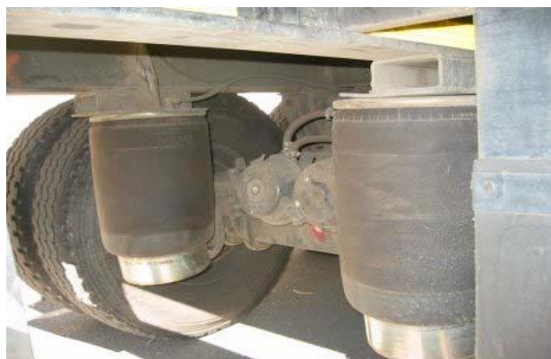
Figura 8: cojinetes neumáticos, eje posterior de un vehículo pesado.
