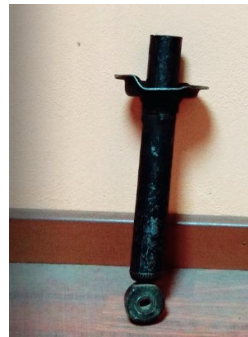
Figura 32: Amortiguador Toyota desmontado
