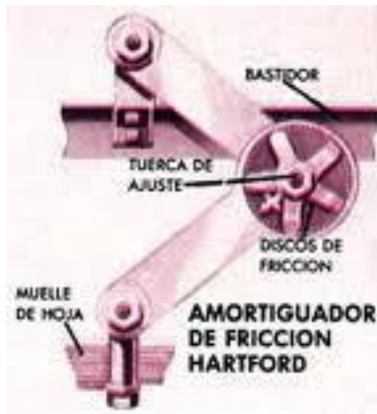
Figura 5: Amortiguador de fricción
