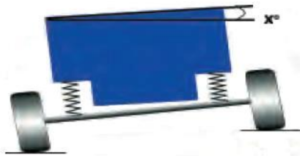
Figura 15: Representación de un eje rígido
