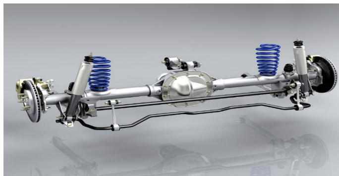
Figura 11: suspensión trasera del Ford Mustang con barra estabilizadora y transversal.
