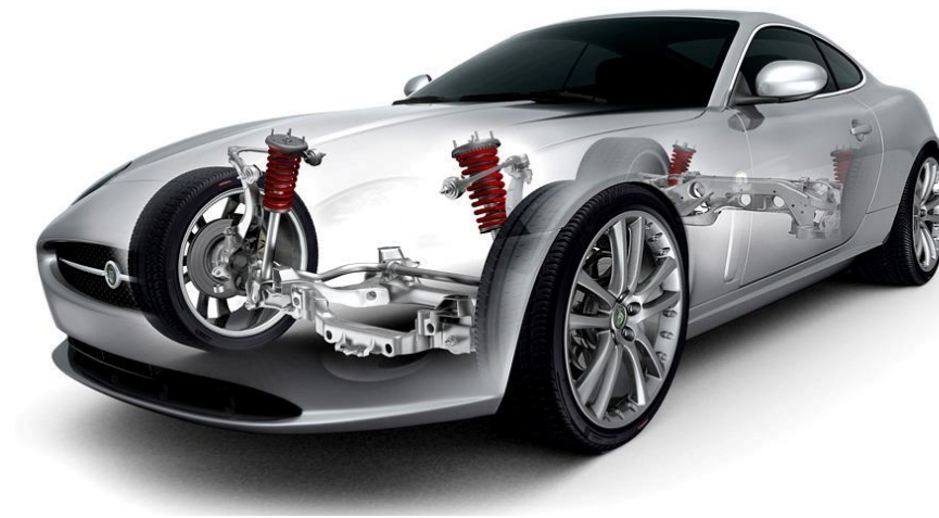
Figura 2: Sistema de suspensión de un Jaguar XF
