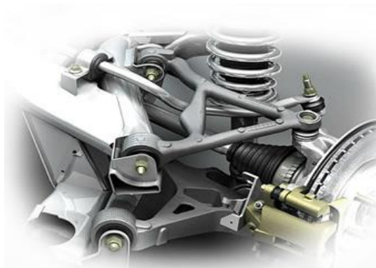
Figura 23: Esquema de una suspensión de paralelo deformable
