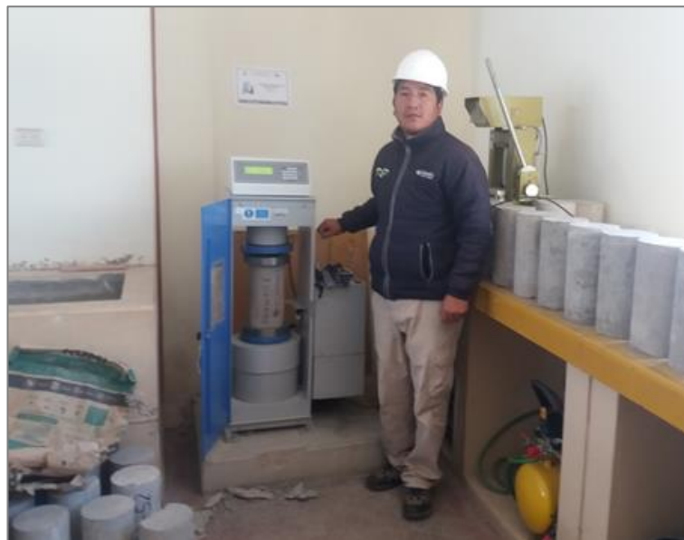
Figura 13: Ensayo de compresión del concreto según NORMA ASTM C 39 Fuente: Elaboración propia
