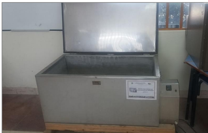
Figura 4: Cámara de curado a temperatura constante marca ORION.
