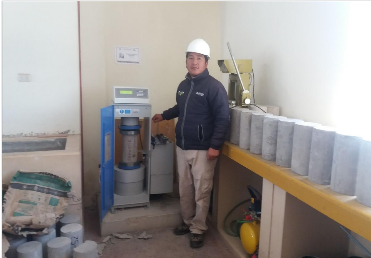
FOTOGRAFÍA 01: ROTURA DE ESPECÍMENES DE CONCRETO DE 6"X12"
