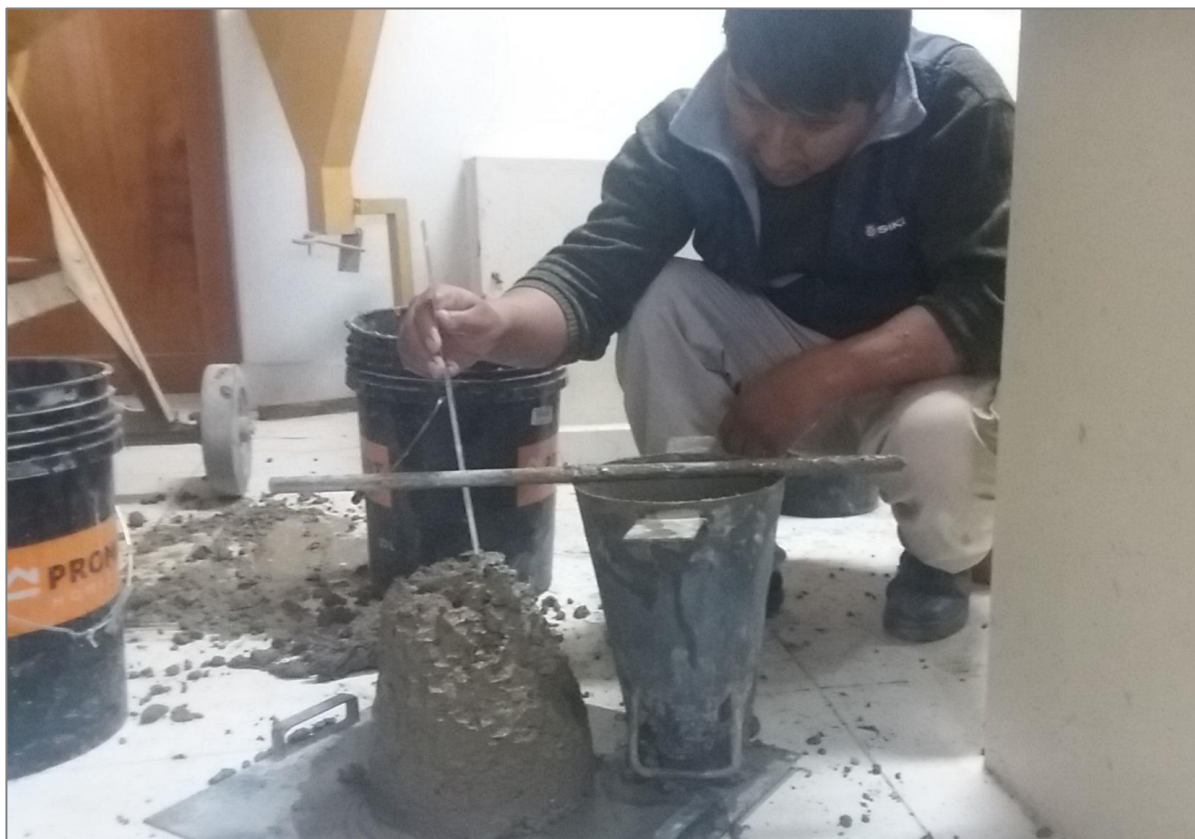
FOTOGRAFÍA 02: PROCEDIMIENTO DE ENSAYO DE CONSISTENCIA DEL CONCRETO
