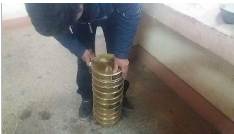
Figura 7: Tamizado de Agregados de la cantera Cutimbo - Puno.
