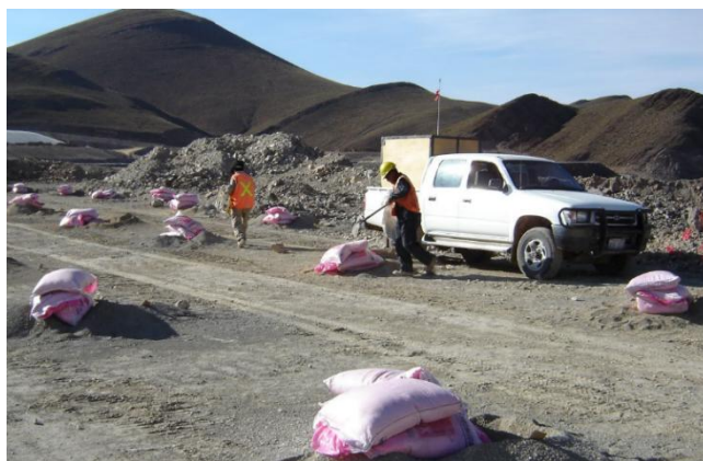
Figura 2.4: Proceso manual de carga de ANFO Fuente: fotografía en operaciones, F. Reátegui
