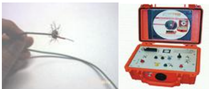
Figura. 3.1: Equipo y cable resistivo Micro Trap® Fuente: MREL Co.
