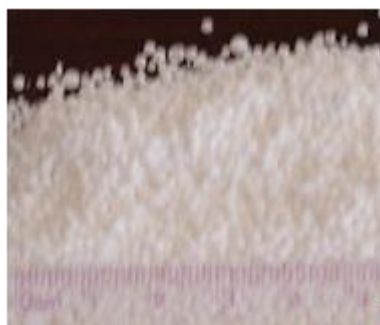
Figura. 3.3: Tamaño de prill de ANFO 16 Fuente: fotografía F. Reátegui
