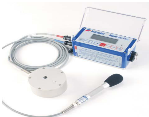
Figura.2.22: Sismógrafo INSTANTEL Minimate Plus®
