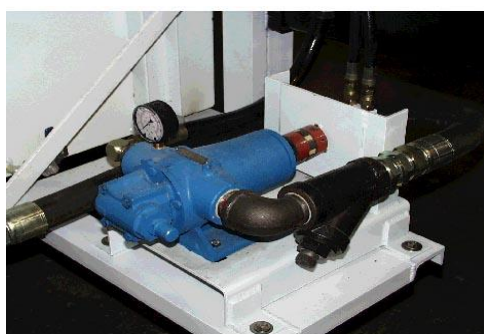
Figura. 2.10: Bomba de engranajes e inyector de Petróleo Fuente: Tread Co.
