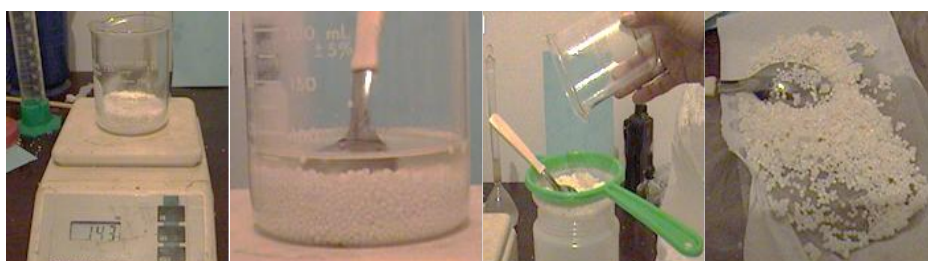
Figura. 3.2: Prueba de absorción de petróleo por el nitrato de amonio Fuente: Fotografía F. Reátegui
