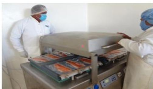
ENVASADO AL VACÍO LOS FILETES DE TRUCHA ARCO IRIS EN MÁQUINA RESPECTIVA DE DOBLE CAMPANA
