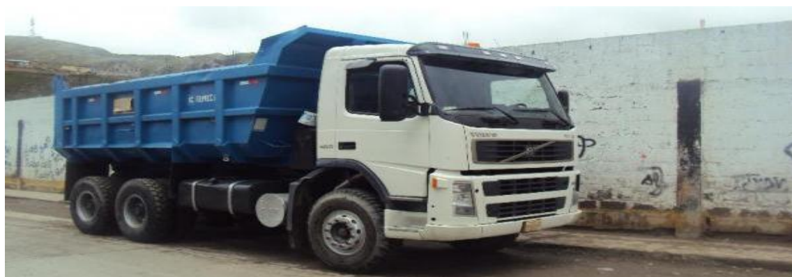
Figura 5. 52. Volquete Volvo FM 440 de 15 cubos de capacidad. marca Volvo FM 440 de 15 metros cúbicos de capacidad, estos equipos son los que transportan las la roca fragmentada de caliza hacia la planta de calcinación, ver Tabla. 5.19.
