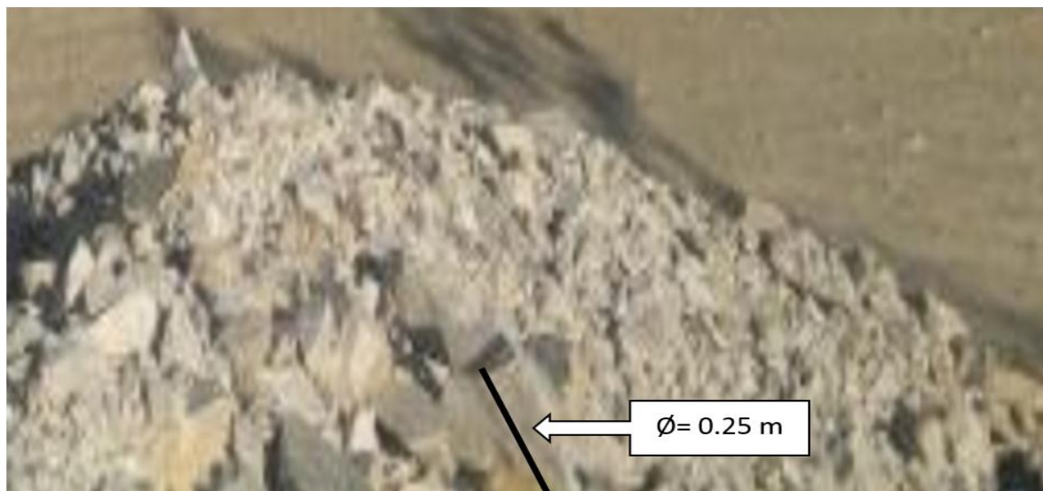
Figura 5. 11. Fragmentos en cancha de calcinado para la trituración secundaria.
