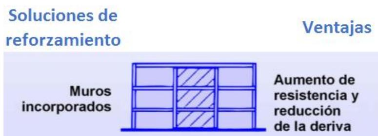
*Figura 2.3: Refuerzo con adición de muros, solución Vs. Ventaja (Tello Malpartida, 2006).*
