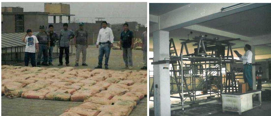
*Figura 2. 35: Carga para prueba de carga en losa Lectura en Deflectómetros para registrar la prueba de carga.*
