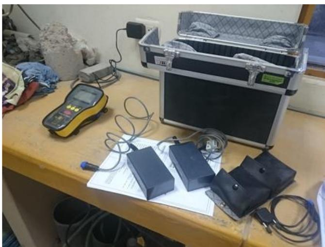
*Figura 4.8: Componentes del MICRO COVERMETER 8010 – Laboratorio de Construcciones Escuela Profesional de Ingeniería Civil.*
