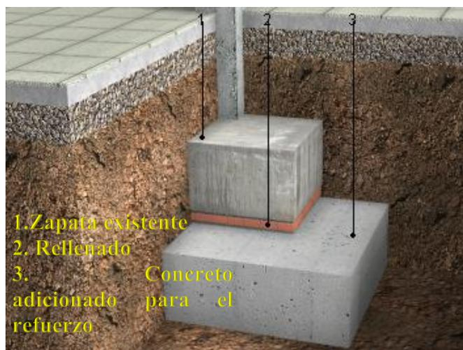
*Figura 2. 29: Aumento de la profundidad del plano de apoyo (Structuralia / Formación especializada, 2016)*
