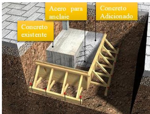
*Figura 2.28: Aumento de las dimensiones en planta (Structuralia / Formación especializada, 2016)*
