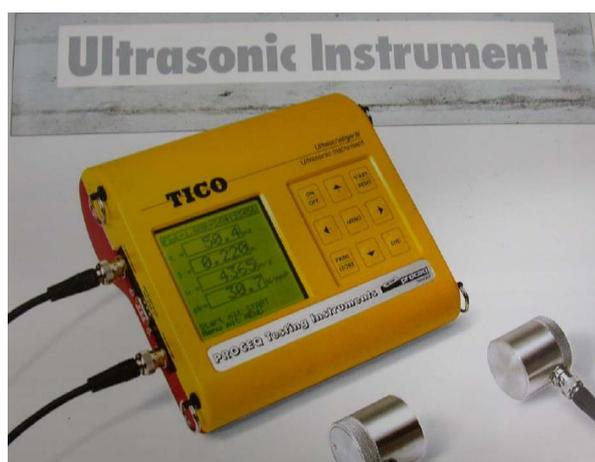
*Figura 2. 41 Instrumento ultrasónico.*
