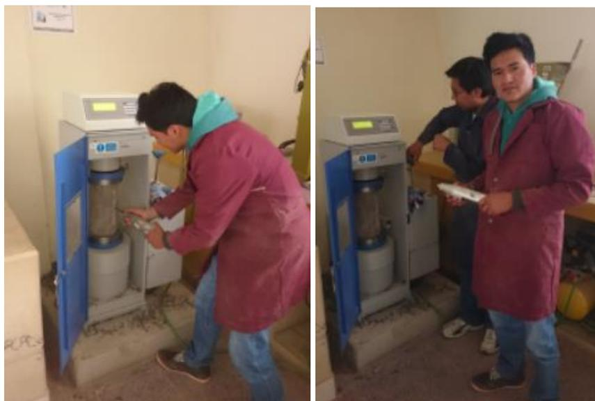
Figura 4.5: Lecturas con esclerómetro a probeta en máquina de compresión.
