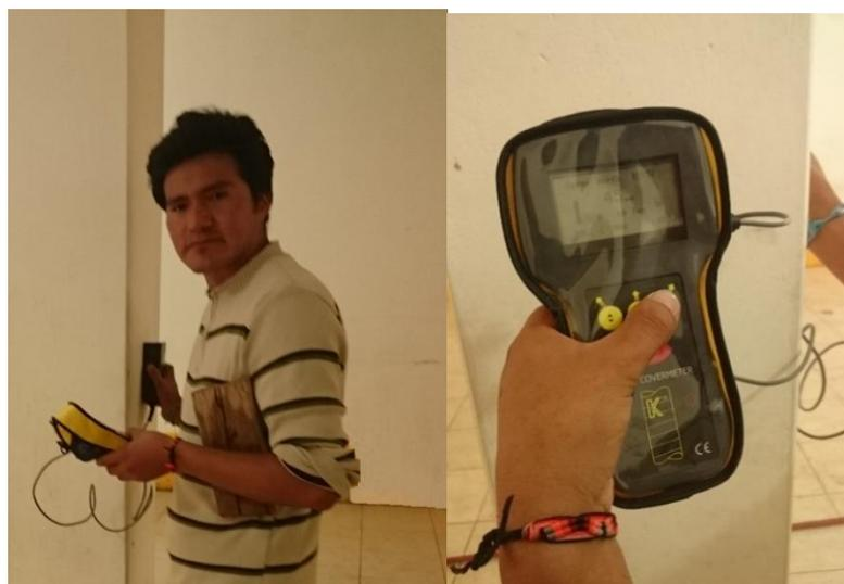
*Figura 4.9: Determinación del acero de refuerzo y recubrimientos con Covermeter – edificio Puno.*
