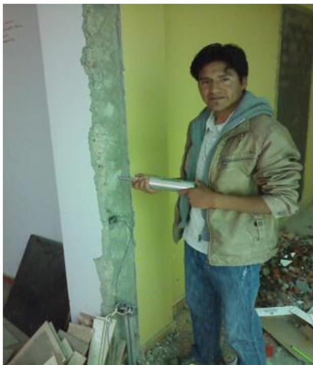
*Figura 4.4: Ensayos no destructivos con esclerómetro realizado en la edificación Puno.*
