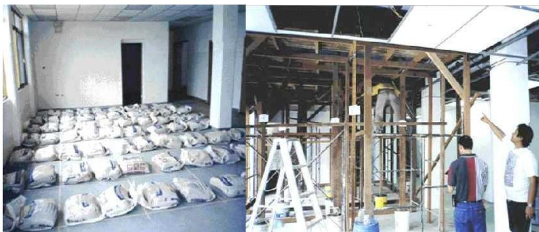
*Figura 2.36: Pruebas de carga para edificaciones.*
