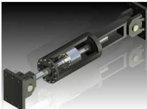
*Figura 2.15: Disipadores de comportamiento fluido viscoso*
