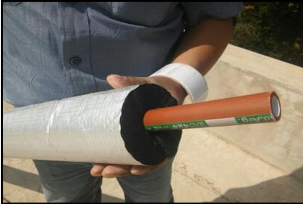
**FOTO 03: Aislamiento de los conductos de agua caliente. (UNA-FIQ).**
