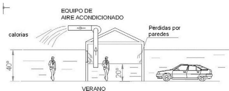
**Figura 13 Extracción de calor en verano**
