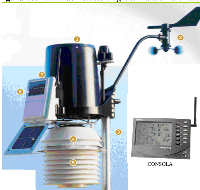
Figura 06: Partes de Estación Agroclimática Automática
