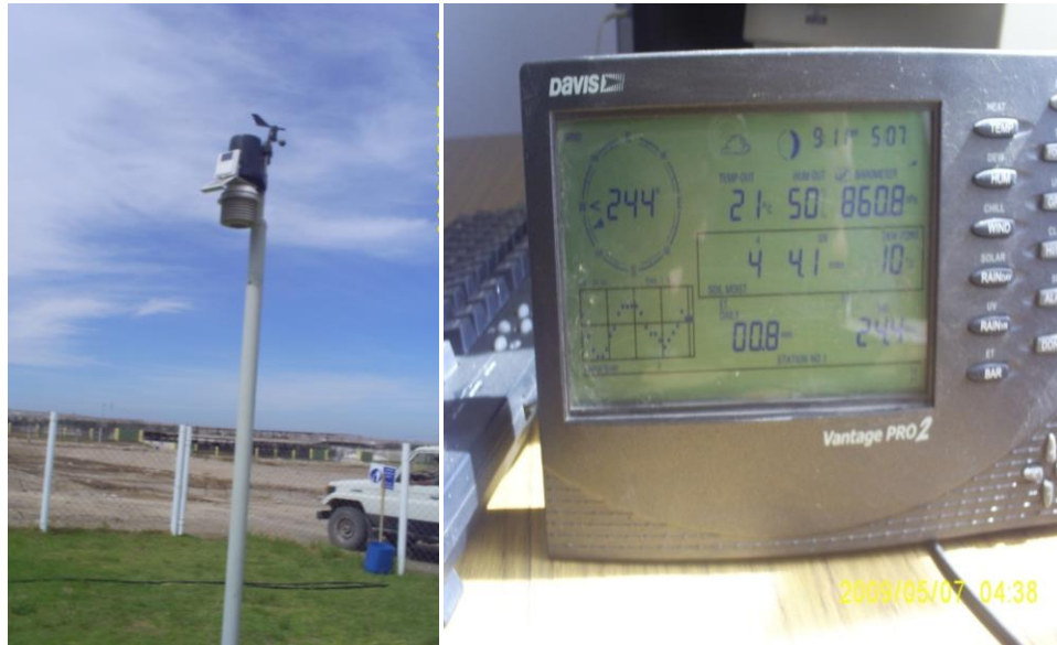
Fotografía 12: Estación Agroclimática Automática (Davis) y Consola Principal de datos
