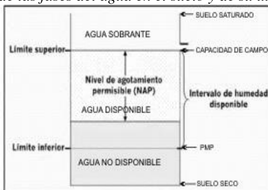
Figura 01: Esquema de las fases del agua en el suelo y de su utilización por las plantas.
