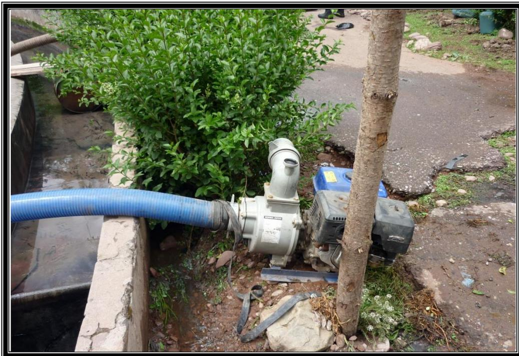
**FOTO N° 10: MOTOBOMBA UTILIZADA PARA EL RIEGO DEL CULTIVO
