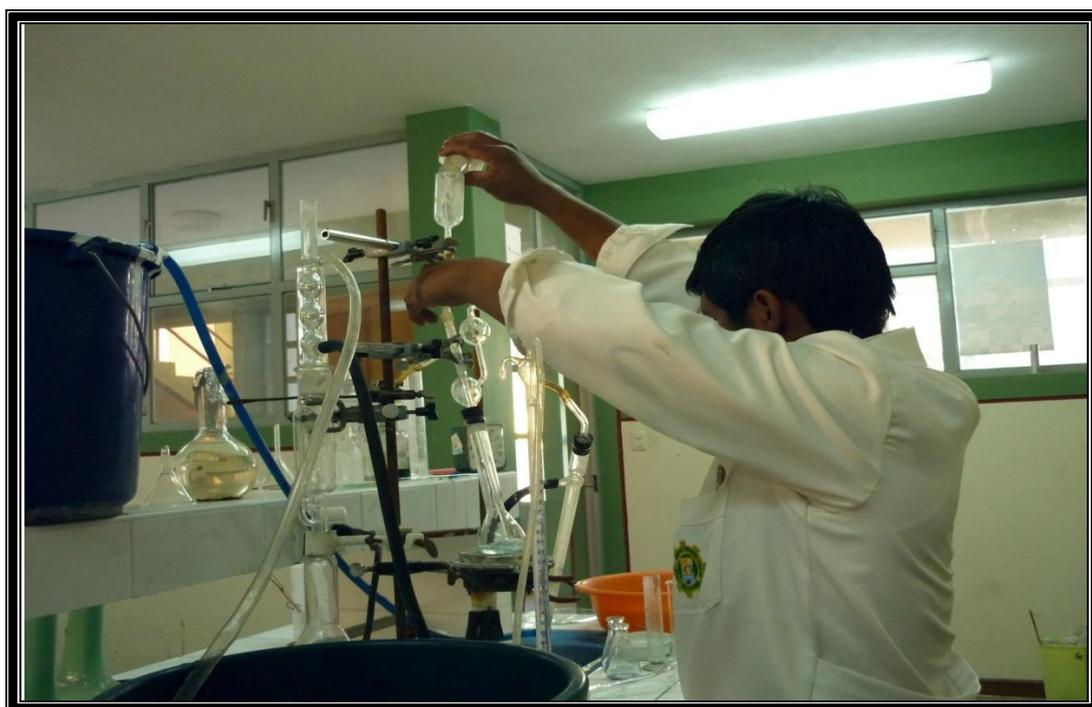
**FOTO N° 16: ANÁLISIS DEL AGUA RESIDUAL TRATADA EN LABORATORIO MÉTODO DESTILAMIENTO Y TITULACIÓN**
