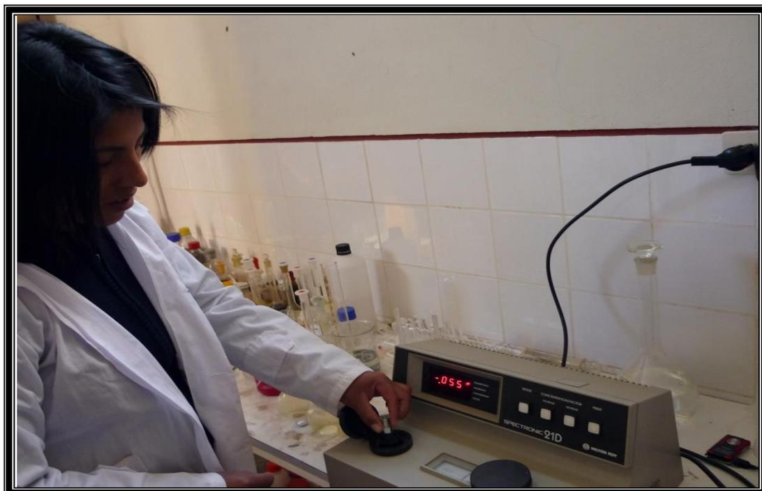
**FOTO N° 15: ANÁLISIS DEL AGUA RESIDUAL TRATADA EN LABORATORIO MÉTODO FOTOESPECTOMETRO**
