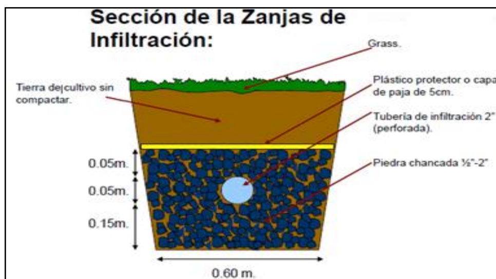
Figura N° 38: Corte de la zanja de infiltración.
