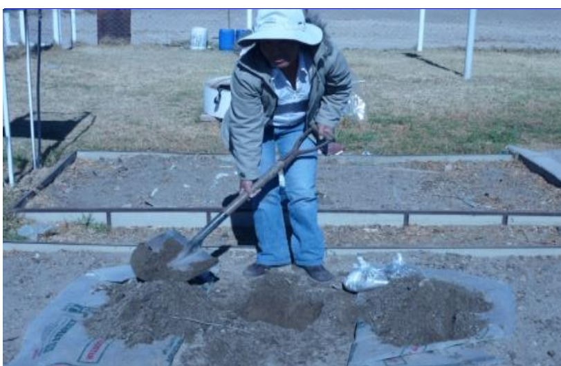
FOTO N° 09: Recojo de muestra, para realizar el análisis de capacidad de campo del suelo en laboratorio.
