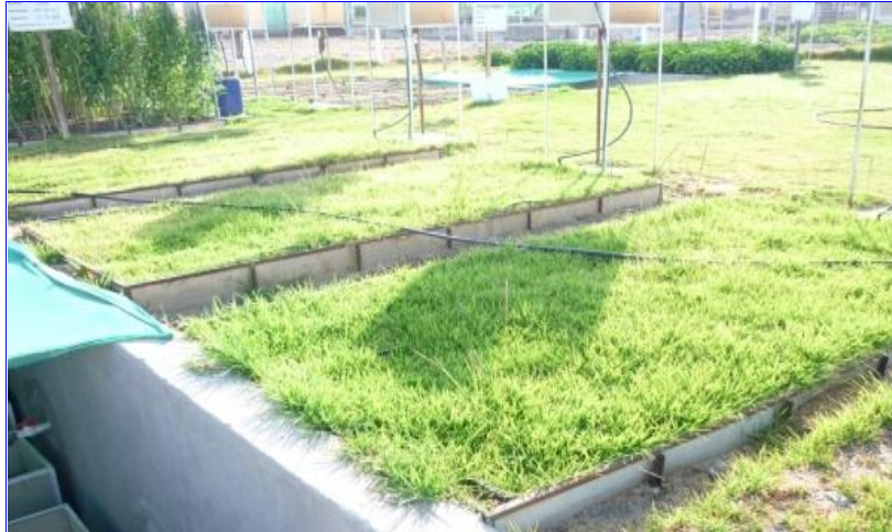
FOTO N° 13: Lisímetro con pasto ray grass para calcular la evapotranspiración potencial de referencia.
