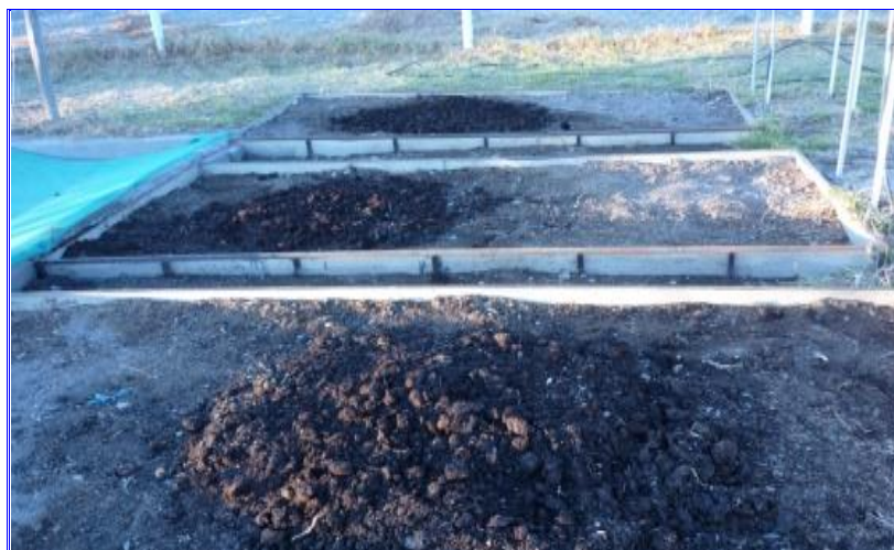
FOTO N° 07: Incorporación de Materia Orgánica al suelo del lisímetro para mejorar la capacidad de campo.
