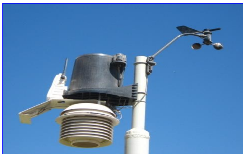
FOTO N° 29: Equipo de estación agroclimática automática.
