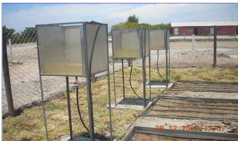
FOTO N° 05: Tanques de aplicación de agua a los lisímetros de cultivo (tanque de cultivo).
