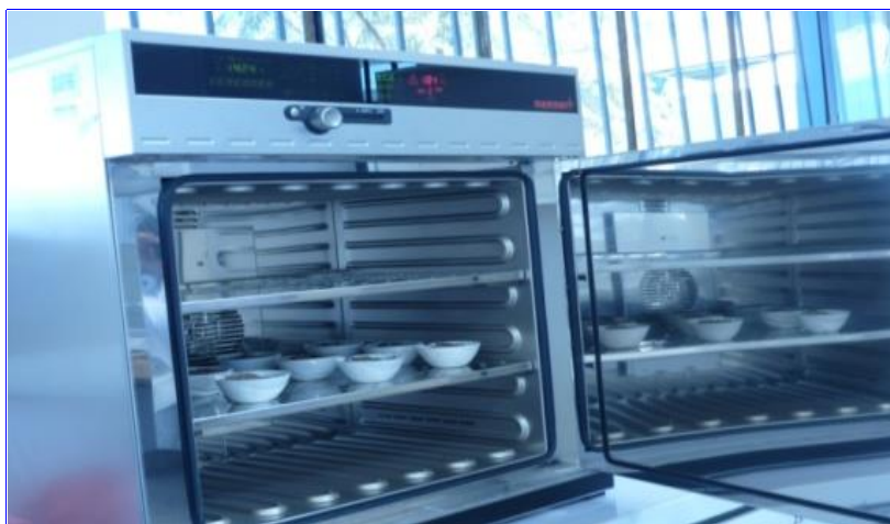
FOTO N° 11: El suelo de lisímetro en estufa para realizar su capacidad de campo.
