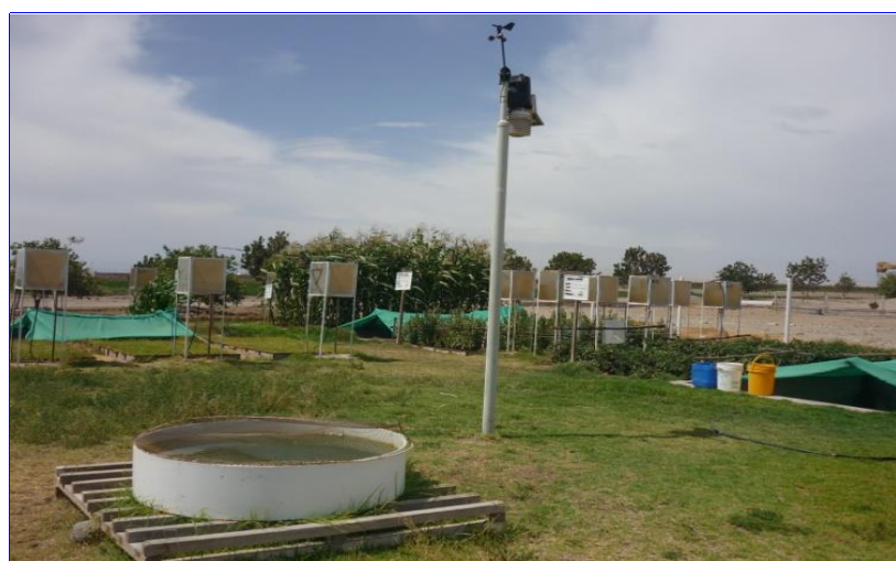
FOTO N° 30: Área de investigación con los equipos instalados, para realizar la investigación, de evapotranspiración real del cultivo de pimiento morrón variedad cierzo.
