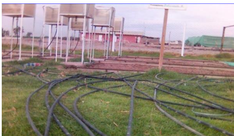
FOTO N° 03: Cintas de riego para realizar el armado sistema de riego, para el lisímetro que se va sembrar el pimiento.
