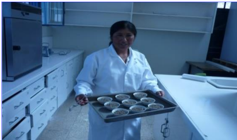
FOTO N° 10: Las muestras previo pesaje se colocara en la estufa para determinar la capacidad de campo.
