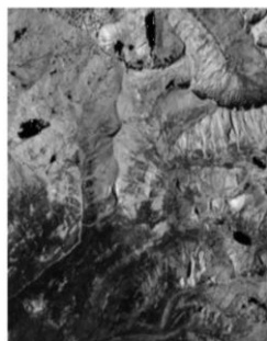
Figura 2.13: Infrarrojo Medio, 2.08 a 2.35 \mu\text{m} (TM 7): Similar a la banda TM 5, pero incluye un elemento de absorción encontrado en minerales de arcilla; materiales con abundante arcilla aparecen más oscuros que en la banda TM 5. Útil para identificar suelos arcillosos y zonas alteradas ricas en arcilla que están comúnmente asociadas con depósitos minerales rentables.
