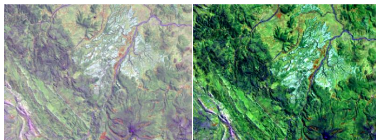
Figura 4.7: Comparación del efecto de la modificación del contraste y brillo
