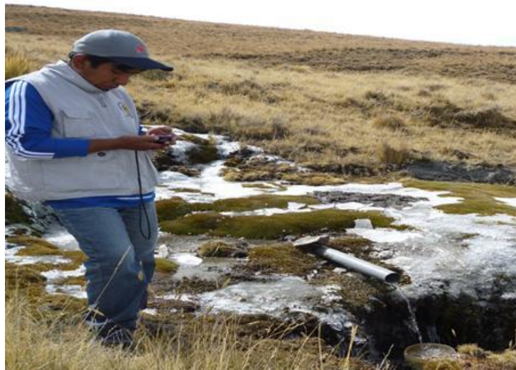
IMAGEN 07: Aforo de los ojos de agua en la parte alta de la microcuenca.
