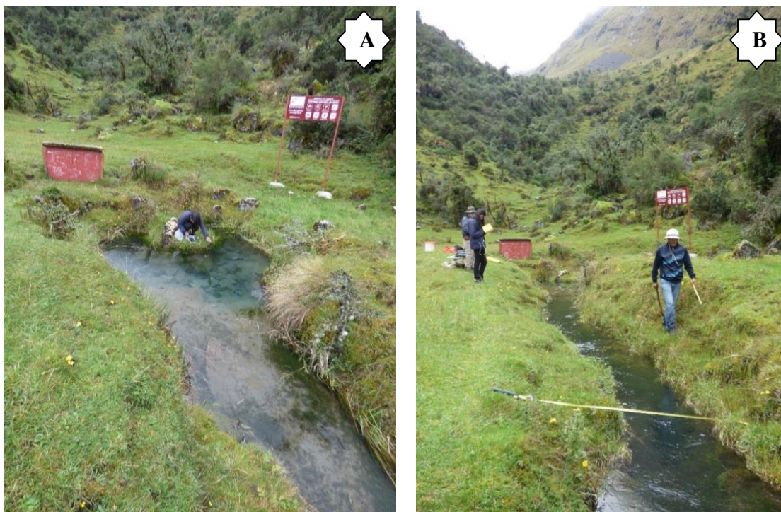
Fotografía N° 1.3. A) y B). Actividades de aforo (cálculo de caudal) del manantial Uspacocha, con el método de un objeto flotante (Manning).
