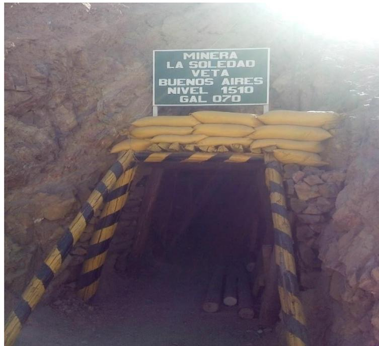
Figura Nº 4: Galería de acceso del nivel 1510, con medidas de Sostenimiento convencional con cuadros de madera.
