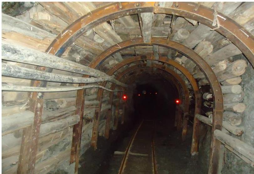
Figura N° 13: Medidas de sostenimiento instalados con cimbra en la progresiva 0 + 850 de la galería de producción, en la Veta Buenos Aires.
