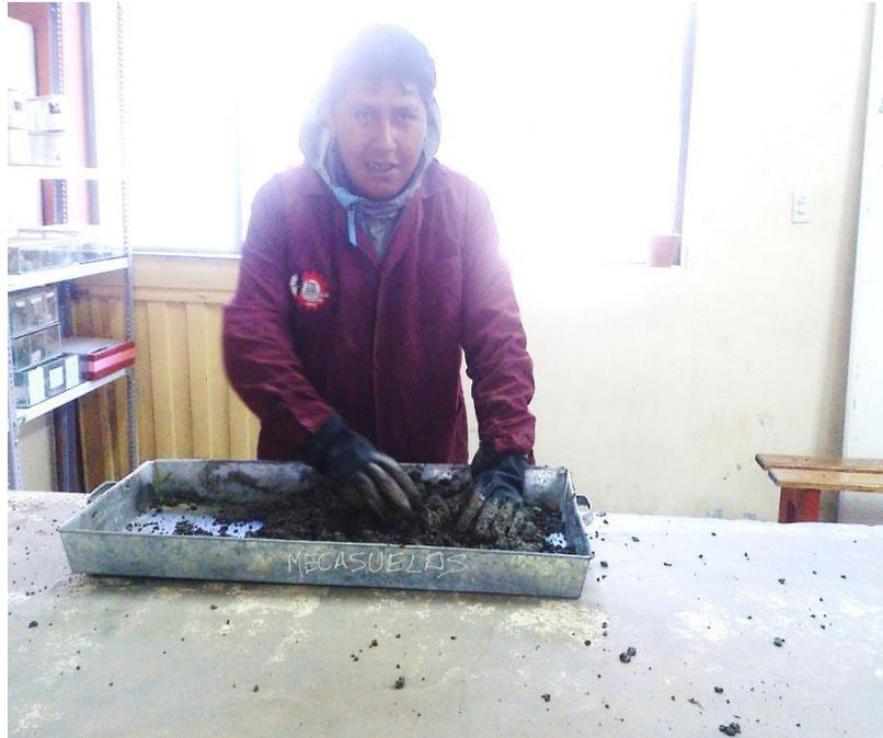
**Figura 13:** Compactando el material con el martillo del ensayo Próctor Modificado.
