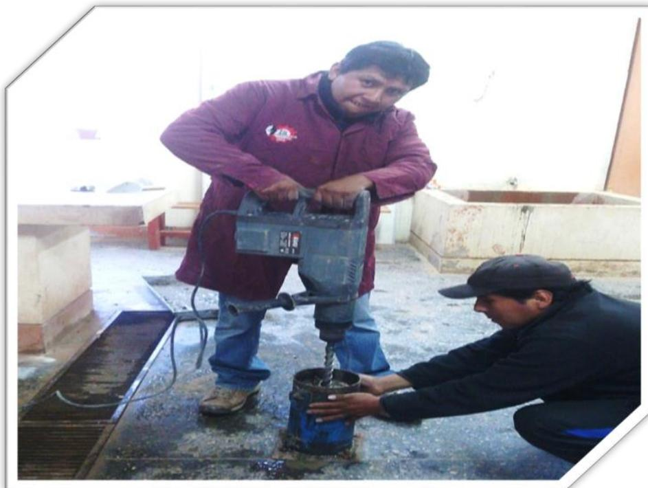
**FOTO 10:** MOLDEO DE ESPECIMENES, 14% CEMENTO
