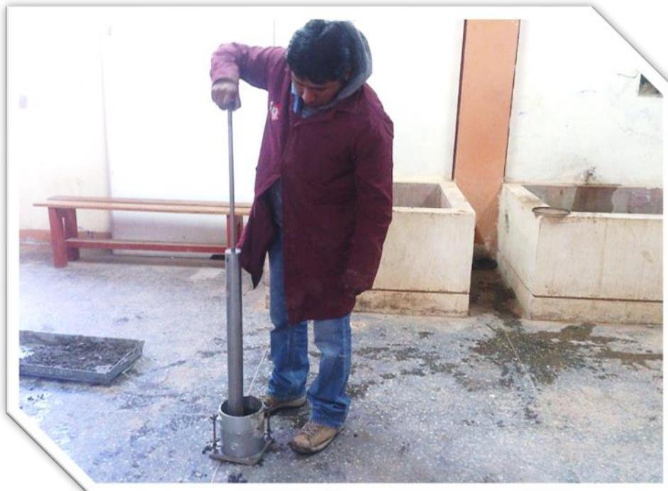
**FOTO 6:** REALIZANDO EN ENSAYO DE PROCTOR MODIFICADO
