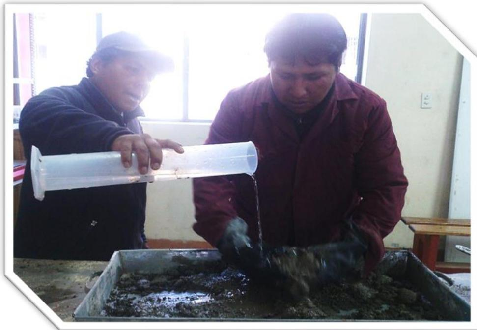
**FOTO 9:** MEZCLA DE MATERIALES, 14% CEMENTO
