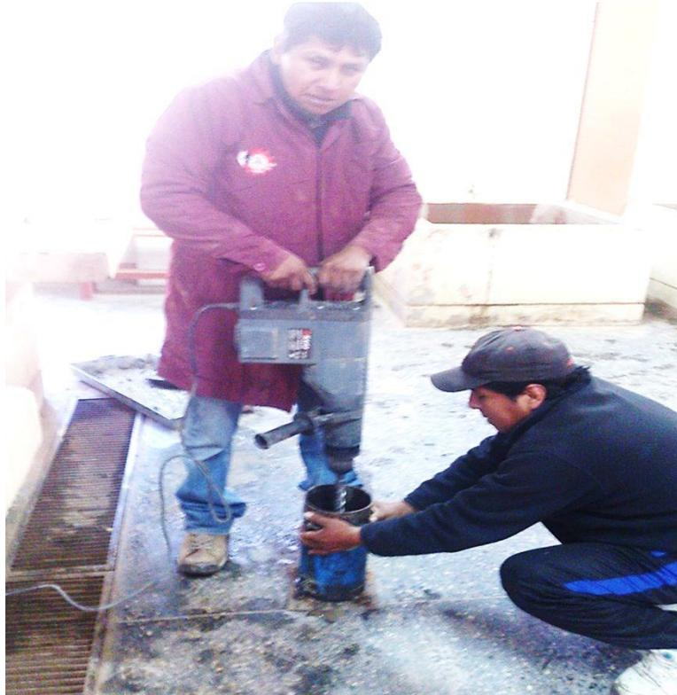
Repetimos el procedimiento de compactación según la alternativa de tiempo establecido, (3 capas de 20 segundos, 4 capas de 15 segundos) para la segunda carga de concreto, rellenando los molde aproximadamente a dos tercios de su volumen. Para la tercera carga, sobrellenados al molde mediante montículos de concreto encima del borde superior del molde con una ayuda de un collarín. De nuevo, colocamos la placa golpeadora en el concreto suelto y compactamos.
