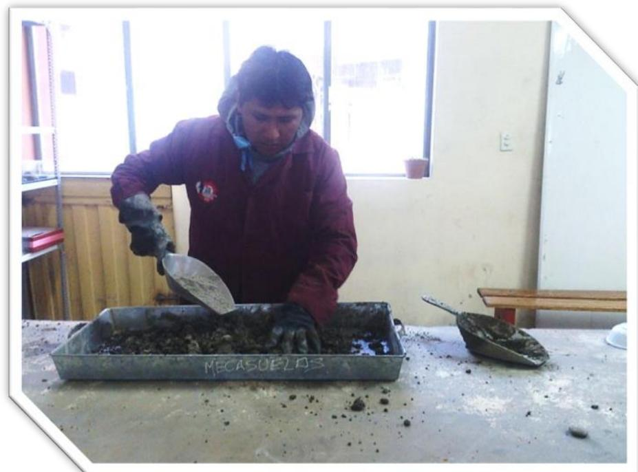
**FOTO 8:** DOSIFICACION DE MATERIALES PARA MEZCLA, 14% CEMENTO.
