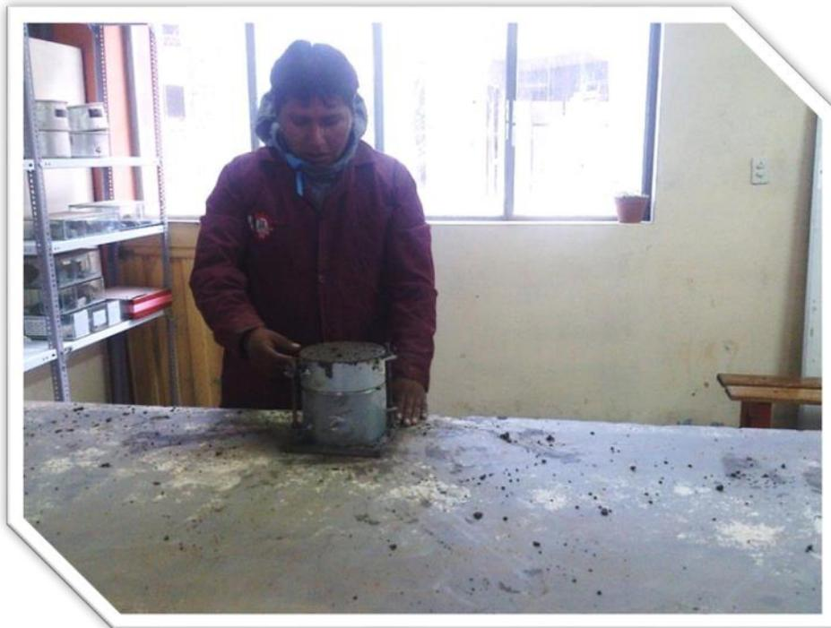
**FOTO 7:** MOSTRANDO EL MATERIAL ENRASADO, CON 14% DE CEMENTO ADQUIERE UNA BUENA CONSISTENCIA Y ACABADO
