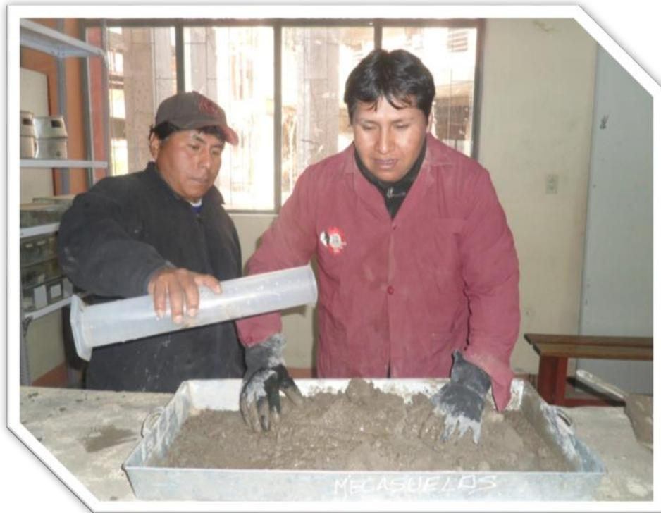
**FOTO 5:** MEZCLA DE MATERIALES PARA REALIZAR EL ENSAYO DE PROCTOR MODIFICADO
