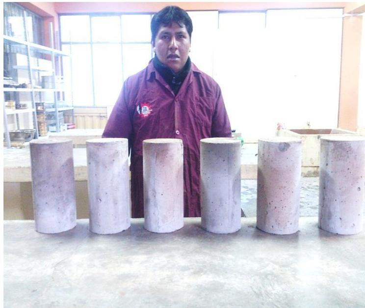
Con el propósito de determinar la resistencia a la compresión de los especímenes, es fundamental que éstos sean curados en forma estandarizada, los especímenes en la investigación fueron curados por inmersión inmediatamente después de ser desmoldados.
