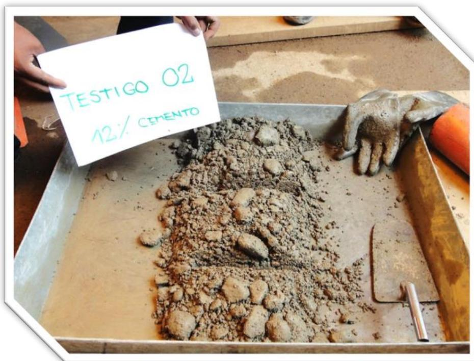
FOTO 4: MATERIAL COMPLETAMENTE MEZCLADO PARA REALIZAR EL ENSAYO
