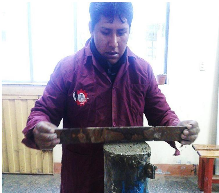
**Figura 25:** Probetas luego del vaciado, compactado y enrasado
