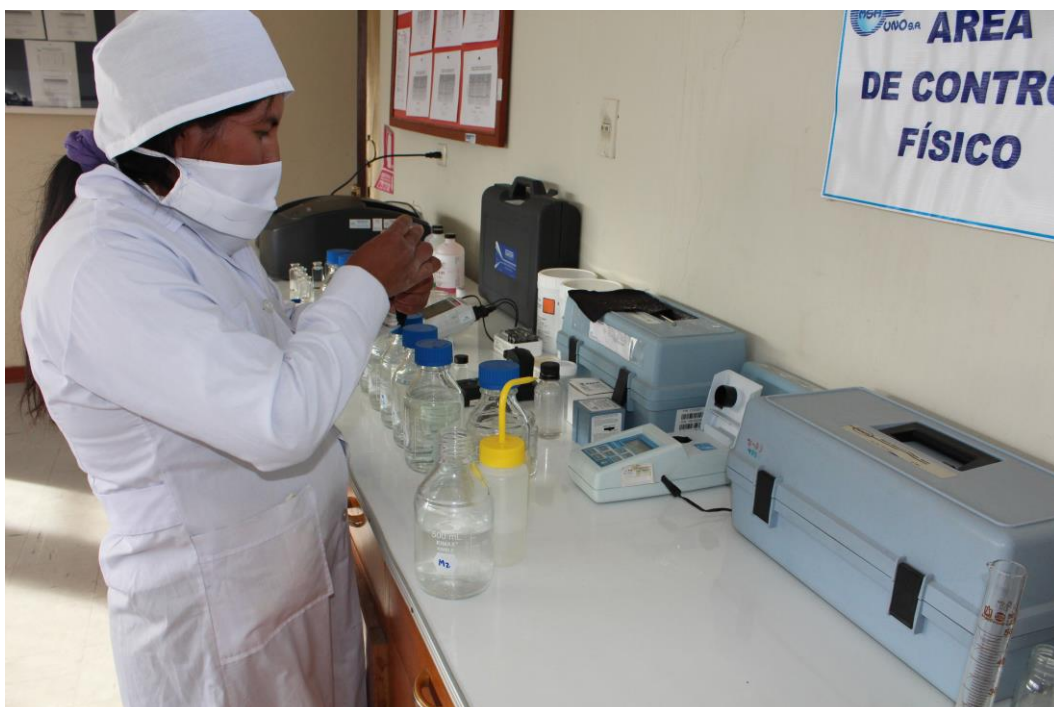
Figura 44. Evaluación de turbiedad (UNT), del agua de pozos provenientes de las cuatro parcialidades del distrito de Huata, febrero 2017.
