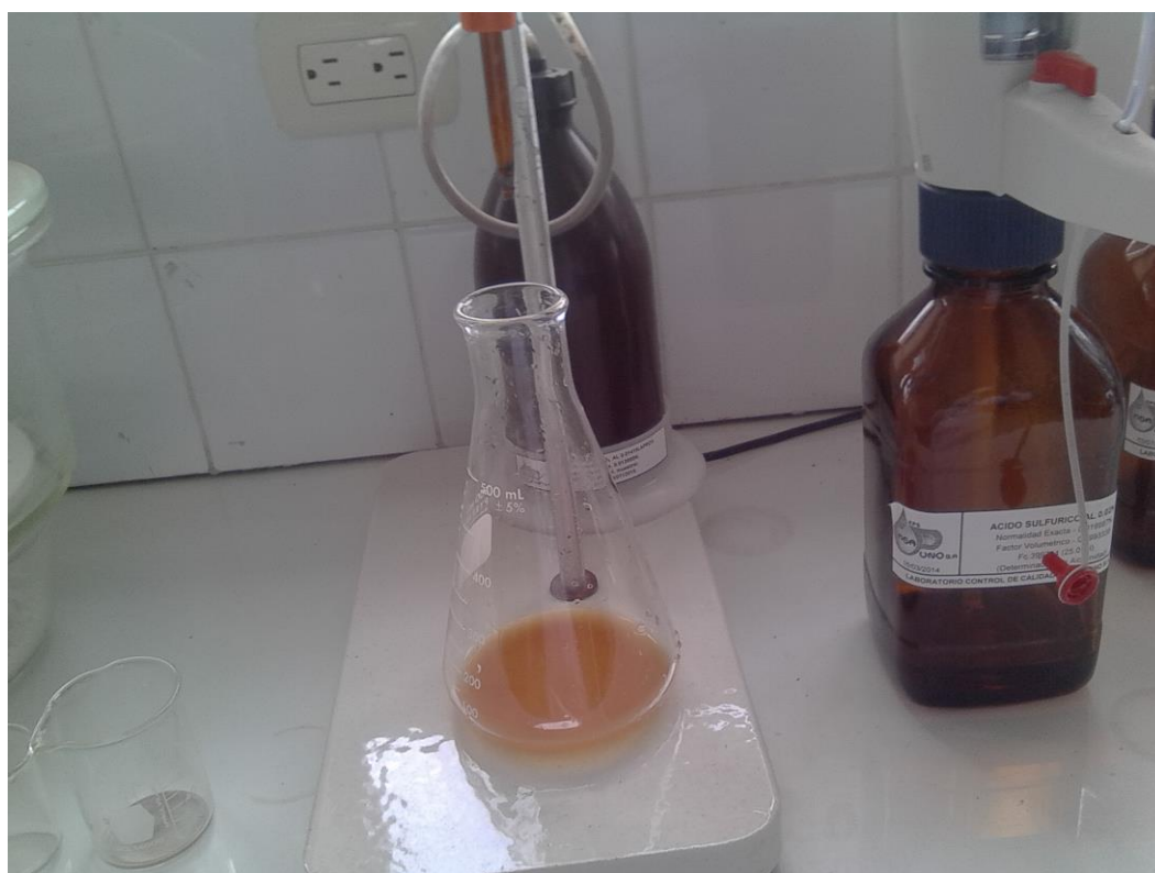
Figura 46. Resultado obtenido de cloruros mediante el método de titulación en el laboratorio de EMSA – Puno, de la muestra de agua de pozos provenientes de las cuatro parcialidades del distrito de Huata.
