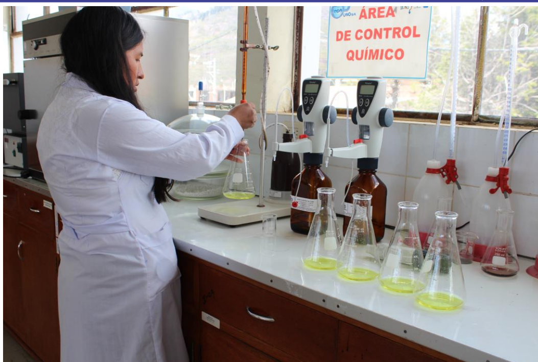
Figura 45. Evaluación de parámetros químicos mediante el método de titulación (dureza, alcalinidad y cloruros) en el laboratorio de EMSA – Puno, de las muestras del agua de pozos de las cuatro parcialidades del distrito de Huata, diciembre 2017.
