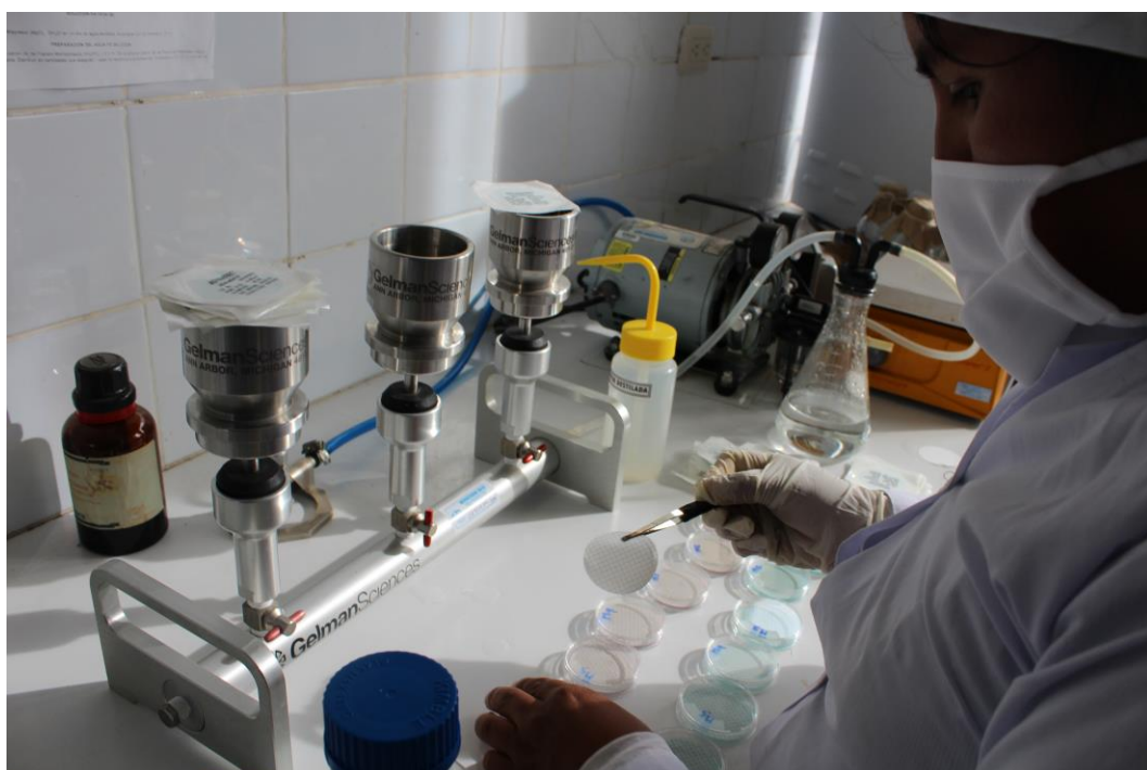
Figura 38. Procesamiento coliformes totales y termotolerantes de muestras del agua de pozos en el laboratorio de EMSA- Puno, provenientes de las cuatro parcialidades del distrito de Huata, febrero 2017.
