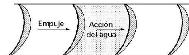
Figura 13: Perfil del Flujo en Turbinas de Acción
