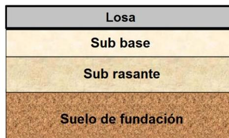
Figura 6: SECCIÓN TÍPICA DE UN PAVIMENTO RÍGIDO.
