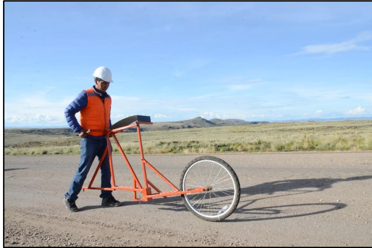
Fotografía N° 29. Operando el rugosímetro Merlin con lecturas cada 2m.
