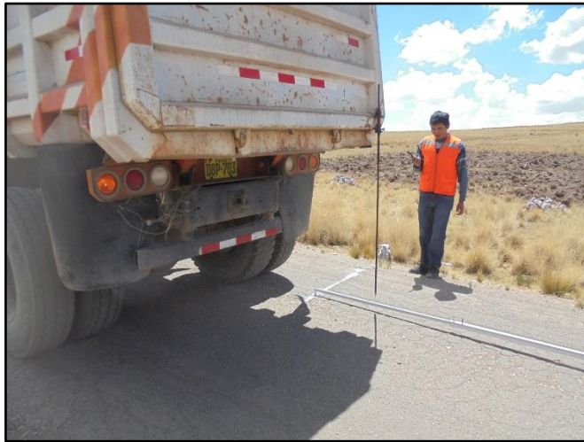
Fotografía N° 21. Deflexión a 25cm del punto de ensayo L25.
