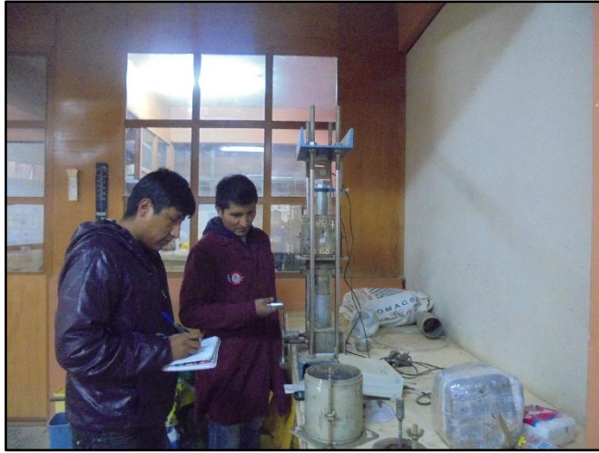
Fotografía N° 49. Lecturas tomadas tanto de las penetraciones como de las cargas.
