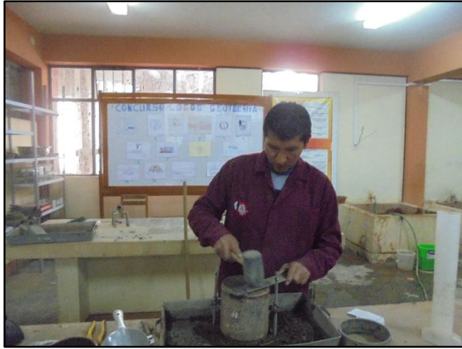
Fotografía N° 46. Enrazado del molde luego de la compactación.
