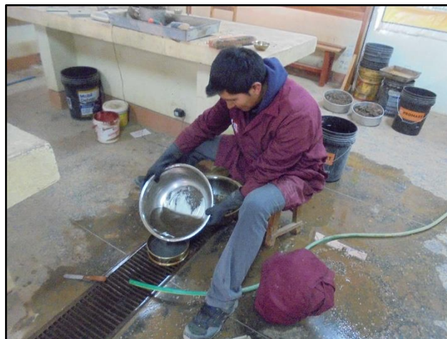
Fotografía N° 36. Lavado de la muestra para en ensayo granulométrico.
