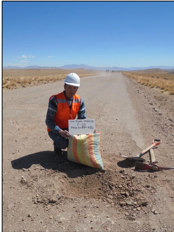
Fotografía N° 32. Calicata C1 – primer tramo crítico.
