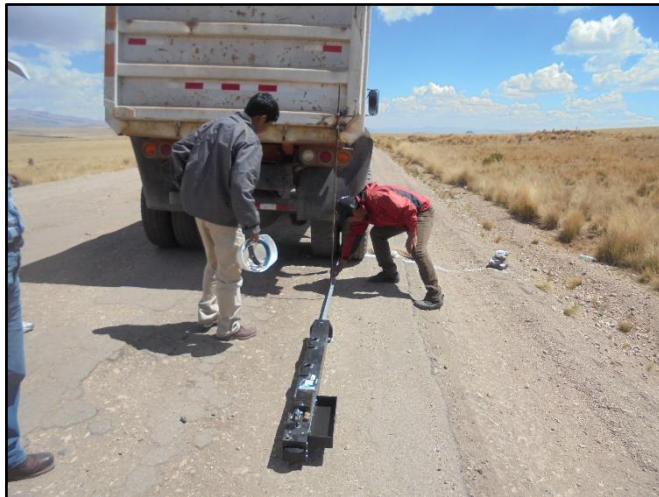
Fotografía N° 18. Colocado de la viga entre las llantas del eje posterior.
