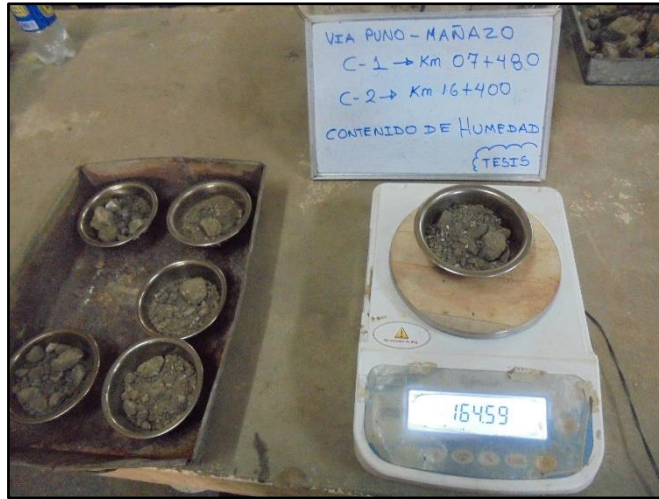
Fotografía N° 34. Ensayo de contenido de humedad C1 y C2.
