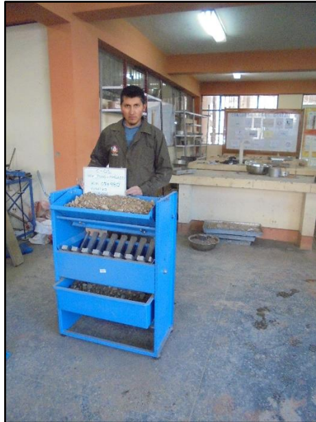
Fotografía N° 35. Cuarteo de muestras para ensayos granulométricos.
