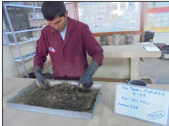
Fotografía N° 44. Mezcla de la muestra con el contenido de humedad óptimo.
