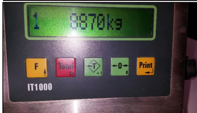
Fotografía N° 15. Registro del pesaje del eje trasero del camión C2.
