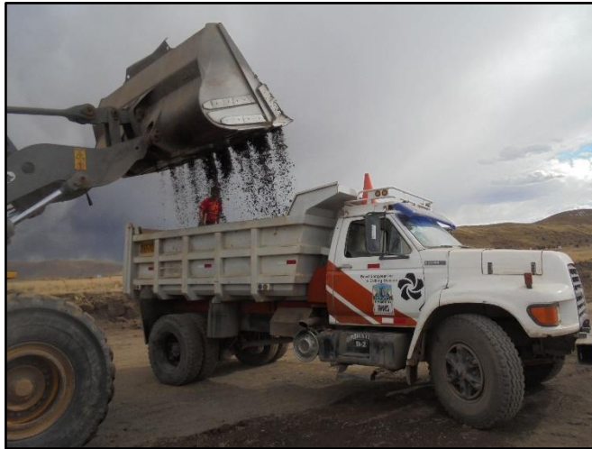
Fotografía N° 12. Carguío del camión C2 con grava para alcanzar los 8.2tn el eje posterior.
