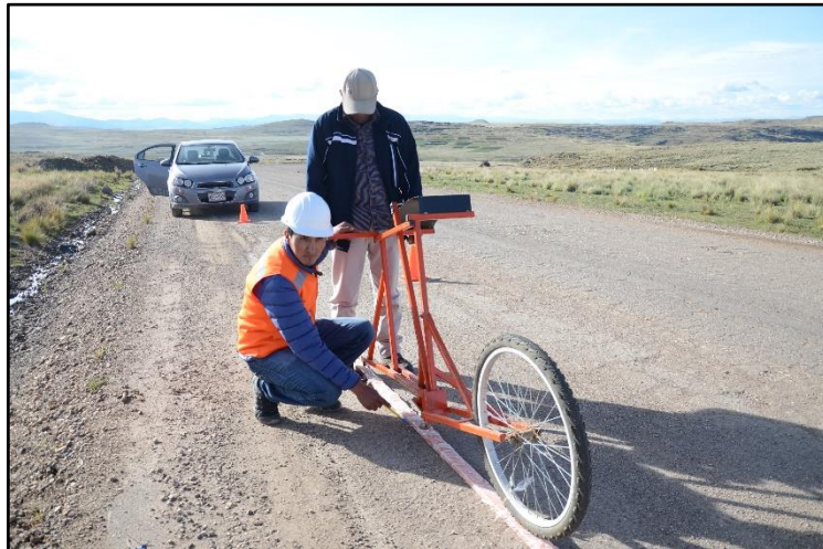
Fotografía N° 27. Calibrando el rugosímetro Merlin y toma de datos para el cálculo del factor de corrección.
