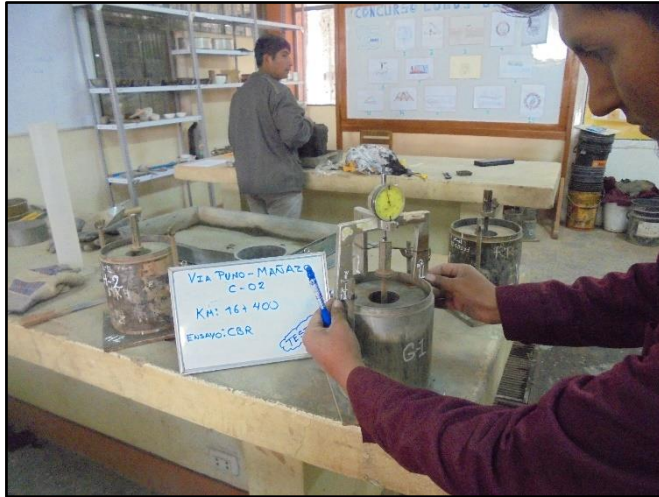
Fotografía N° 47. Colocado de marcas para el apoyo del deformímetro.
