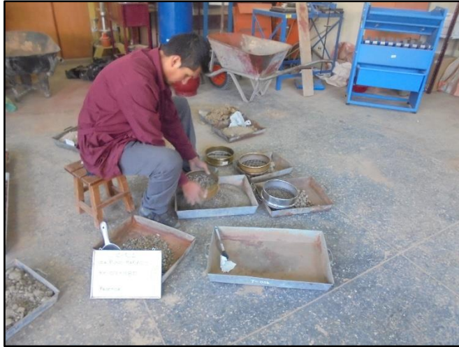
Fotografía N° 40. Tamizado para hallar el método para realizar el ensayo Proctor.
