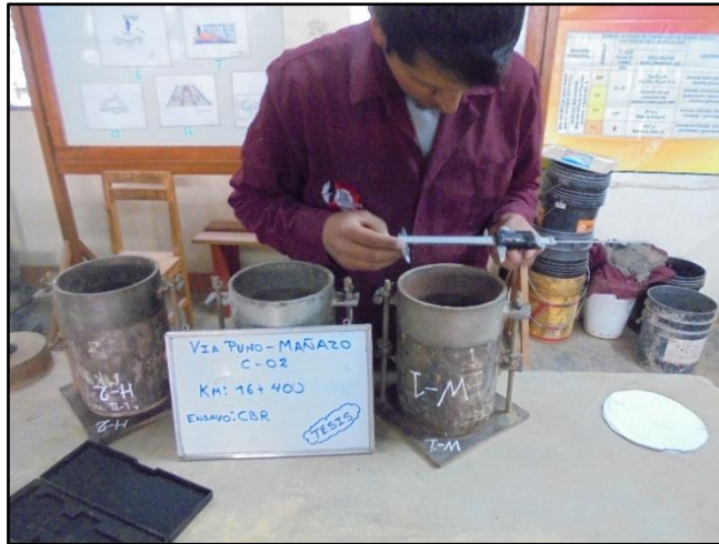
Fotografía N° 43. Medida de los moldes a usar en el ensayo de CBR.
