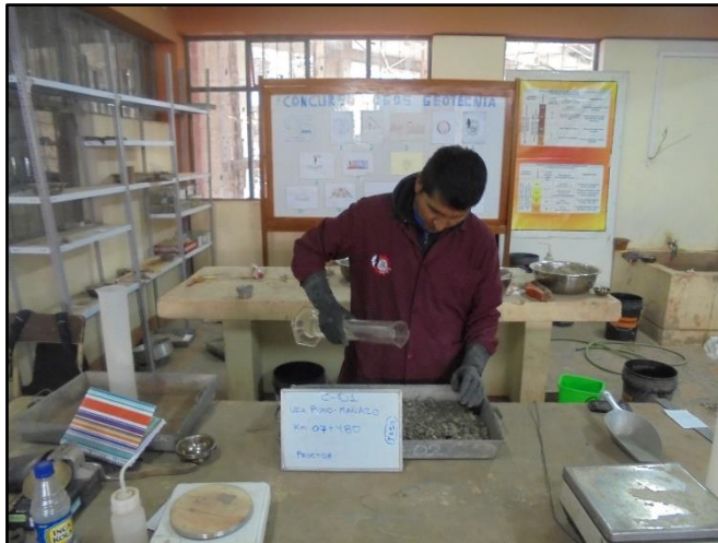
Fotografía N° 41. Incremento de humedad a la muestra para ser compactada.
