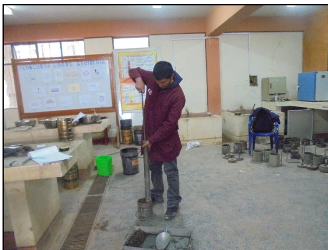
Fotografía N° 42. Compactación de la muestra con humedad controlada en el molde Proctor.
