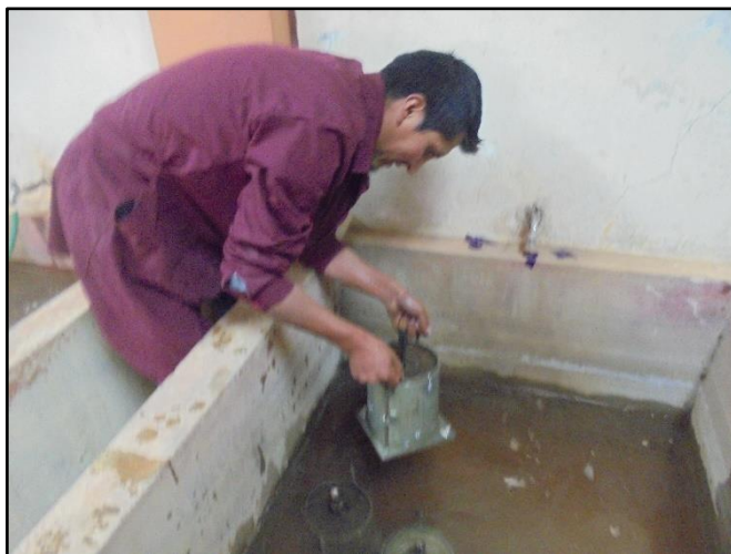
Fotografía N° 48. Introduciendo los moldes CBR con muestras compactadas en la posa de agua.
