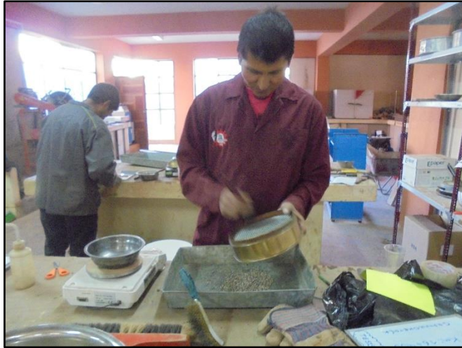
Fotografía N° 37. Pesado de las muestras retenidas en los diferentes tamices.
