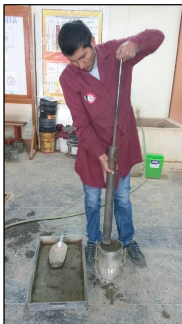
Fotografía N° 45. Compactación de la muestra en el molde CBR.
