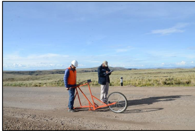
Fotografía N° 30. Ensayo de índice de rugosidad internacional en los tramos críticos.
