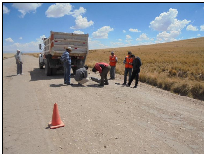
Fotografía N° 16. Equipo de trabajo para ensayo de Viga Benkelman.
