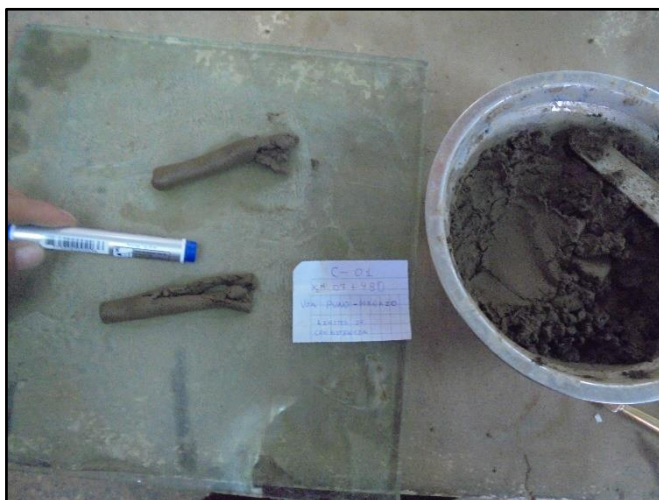
Fotografía N° 39. Ensayo límite plástico que resultó ser un suelo NP.
