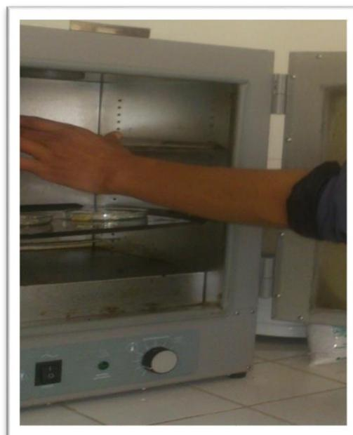
**Fotografía N° 11. Realización del análisis de la humedad en el lodo residual.**
