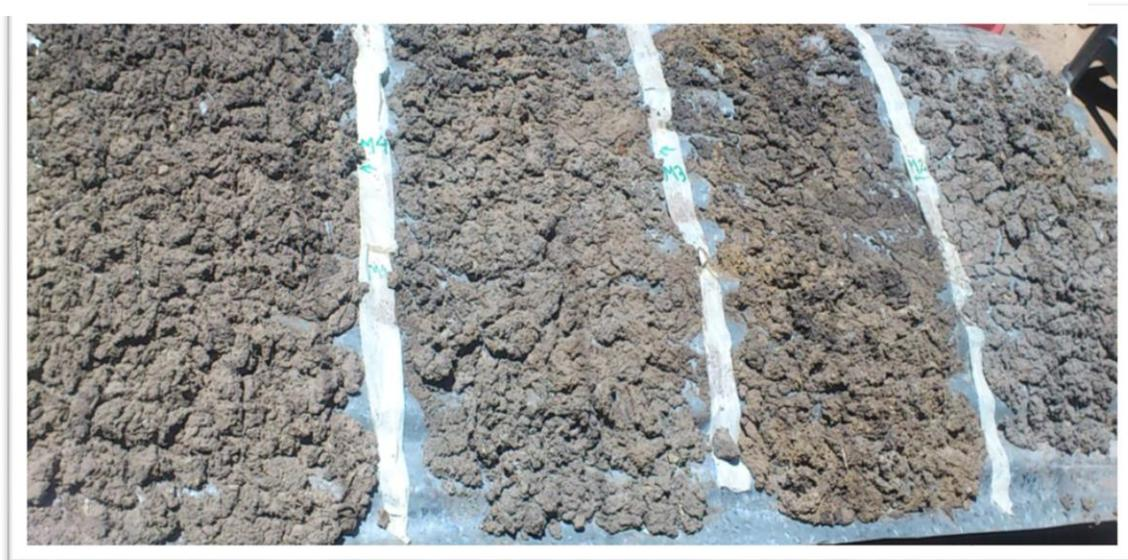
**Fotografía N° 9. Lodo residual después del proceso de secado.**
