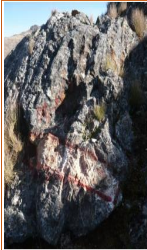
Figura N° 14: Canal de muestreo hecho por SNS en el Sotckwork, nótese el venilleo de cuarzo lechoso, sin presencia de molibdenita M-10.
